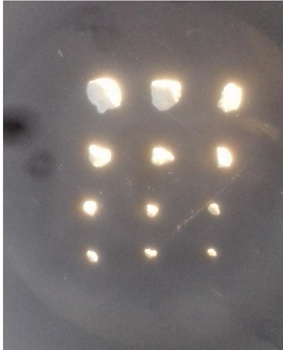
Fotografía N° 10: Forma y tamaños de la muestra sacada durante el tamizado de Zeolita
