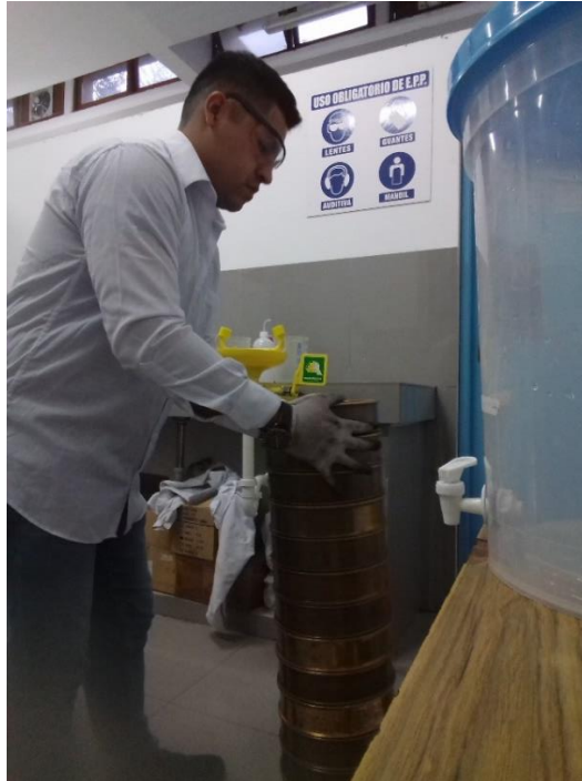
Fotografía N° 08: Tamizado de las muestras de Antracita y Zeolita
