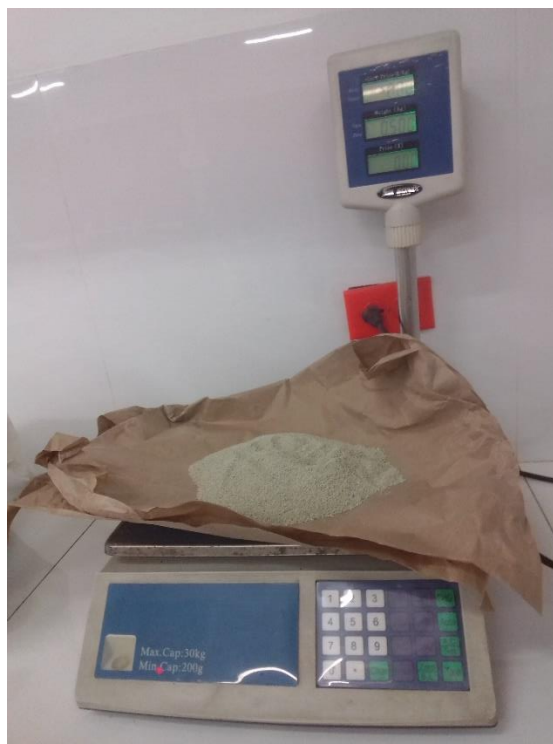
Fotografía Nº 07: Pesado de una muestra de Zeolita para la Determinación de su Granulometría
