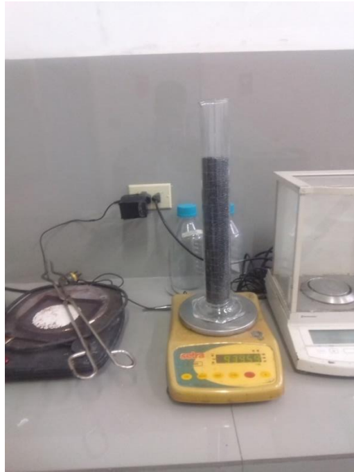
Fotografía N° 03: Determinación de la Densidad y Porosidad - Antracita
