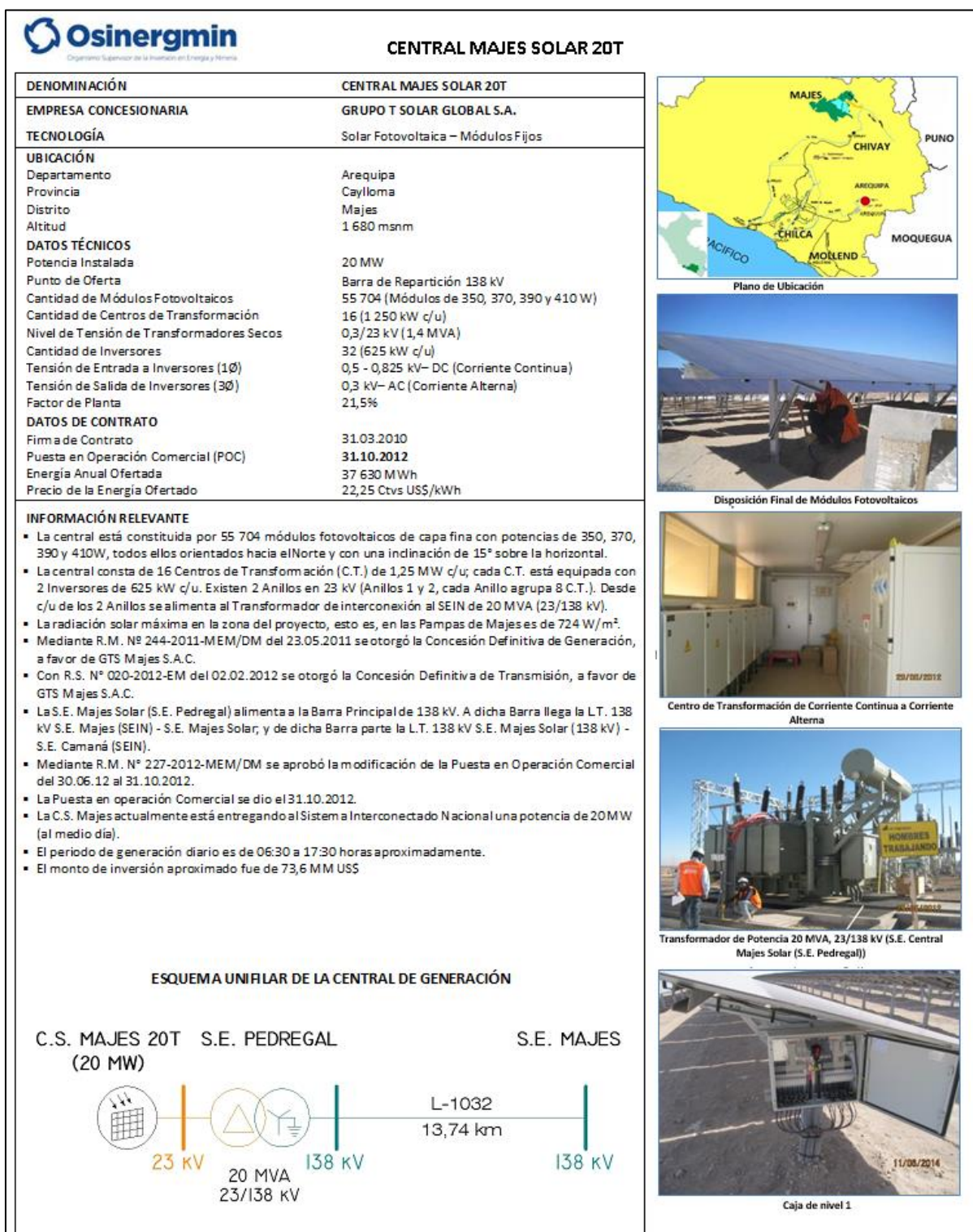
Figura 60: Ficha Técnica de la Central Majes Solar Fuente: (Dirección de Supervisión-Osinerghmin, 2019)
