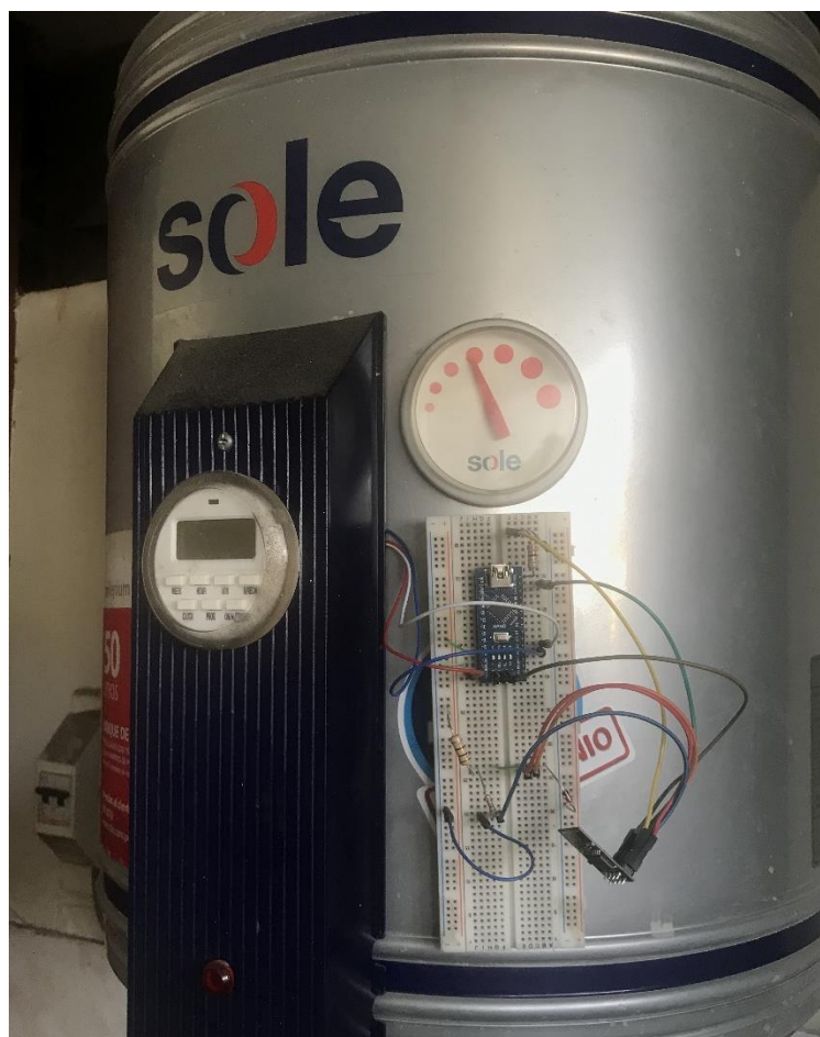
Figura 4.12 Terma con su circuito de control instalado (Fuente: Elaboración propia)
