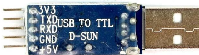
Figura 2.20 Conversor USB a Serial TTL (Módulo PL2303) (Fuente: Naylamp Mechatronics [57])
