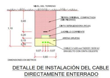
**DETALLE DE INSTALACION DEL CABLE DIRECTAMENTE ENTERRADO**
