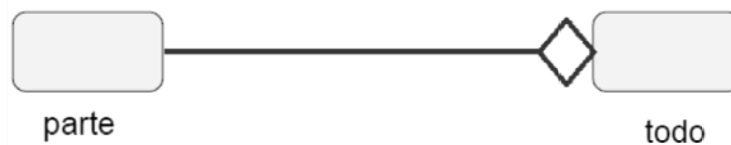
FIGURA 2.13: Representación de una agregación
