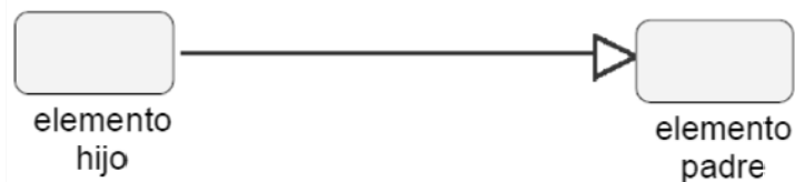
FIGURA 2.14: Representación de una generalización
