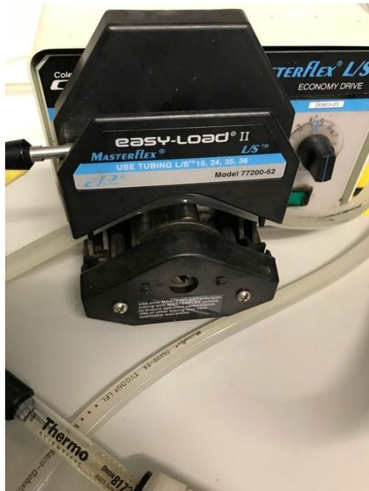
La bomba peristáltica mostrada es la que inyecta el agua con el caolín en el sistema de tratamiento. Es la bomba que hace pasar a través del serpentín y el sistema de del mezclador estático el agua a tratar.
