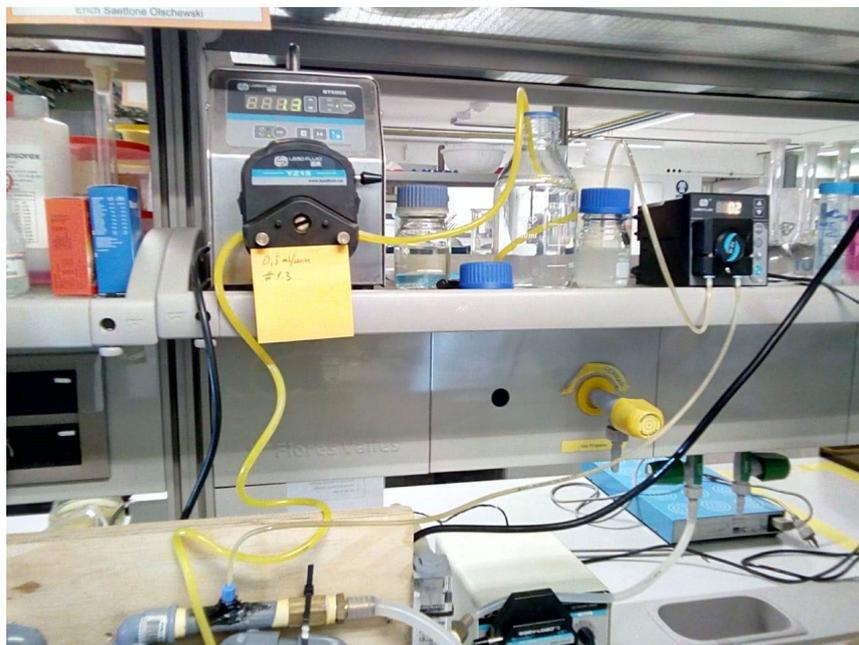
Para una mezcla uniforme se ha realizado un serpentín figura 19, en una tubería de  $\frac{1}{2}$ " pulgada con una distancia equivalente de 2.5 m, a la derecha de la figura se aprecia un medidor de caudal para determinar el correcto caudal del sistema. El diámetro de la tubería se debe al caudal del procesamiento (figura 20).
