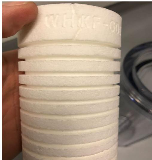
Este es el tipo de filtro que se ha pensado utilizar para atrapar los Floccs, debido a que nos permite filtrar el tamaño de partícula adecuado, además es un filtro fácil de reemplazar y de encontrar en el mercado.
