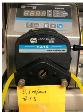
Esta es la bomba que se encarga de suministrar el floculante en un caudal de 0.5 ml/min al Sistema de purificación de agua. Esto en concordancia al diámetro de la tubería y al caudal necesario en el sistema propuesto.
