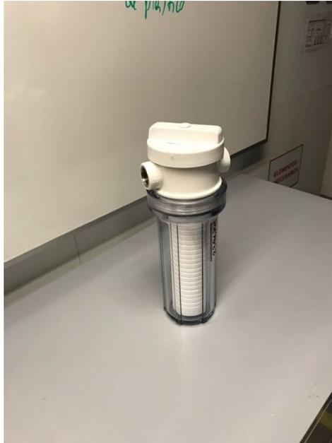
Para el proceso de filtrado sea pensado en utilizar un filtro de 5 micrones que permitirá atrapar los Floccs en su interior.
