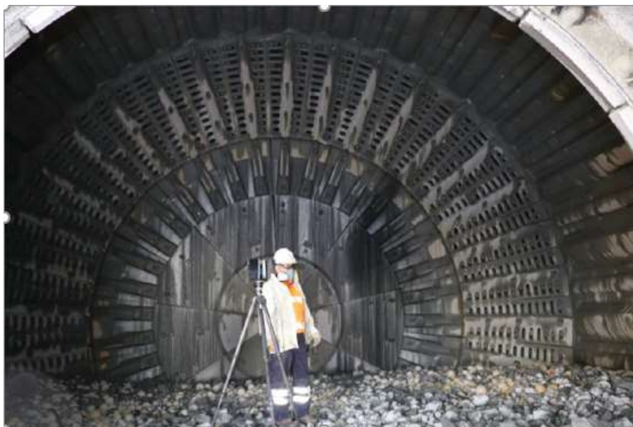
Figura 4.32: Nivel de carga llega a la altura del Pulp Discharge
