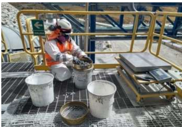
Figura 3.20: Control de Setting -1/2" por la faja CVB0015.
