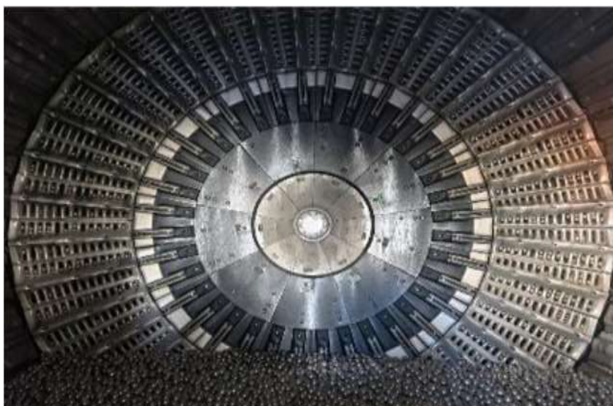
Figura 4.35: El nivel de bolas por encima del middle liner
