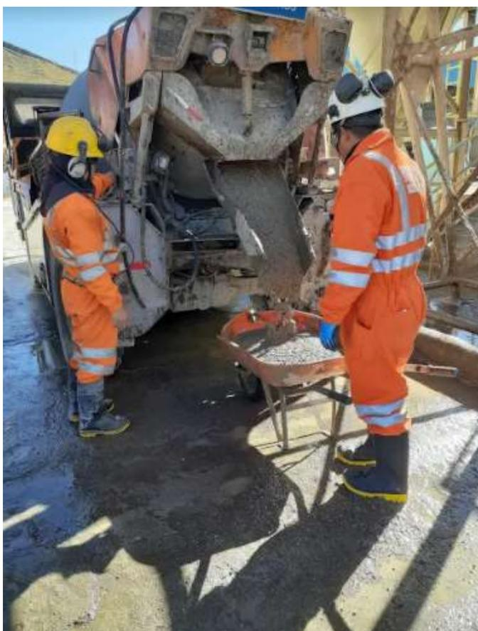
Figura N° 16: Control del Slump en planta
