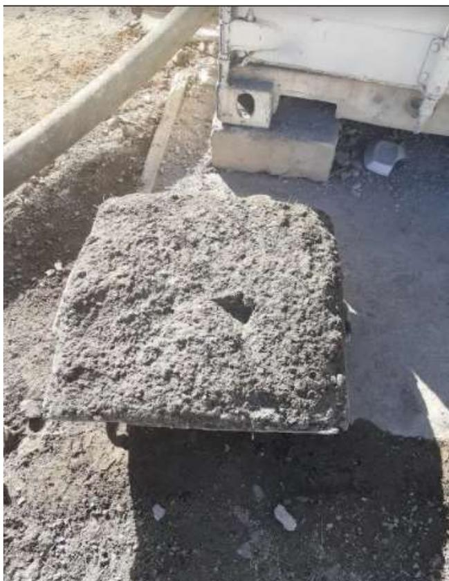
Figura N° 15: Preparación de los paneles de Shotcrete
