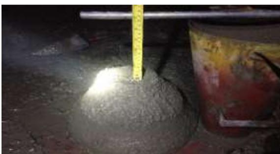
Figura N° 20: Slump – Fibra Barchip R50 ( Mina)
