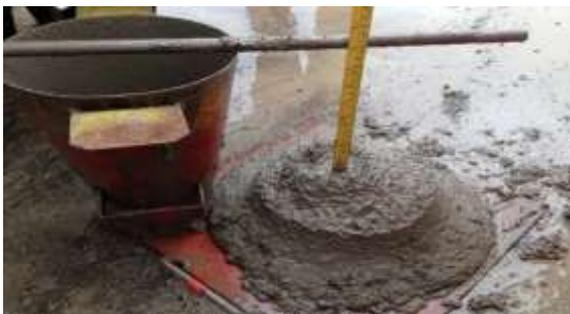
Figura N° 19: Slump – Fibra Barchip R50 (Superficie)
