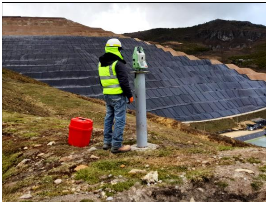
Figura 4.5 Monitoreo de prismas reflectores
