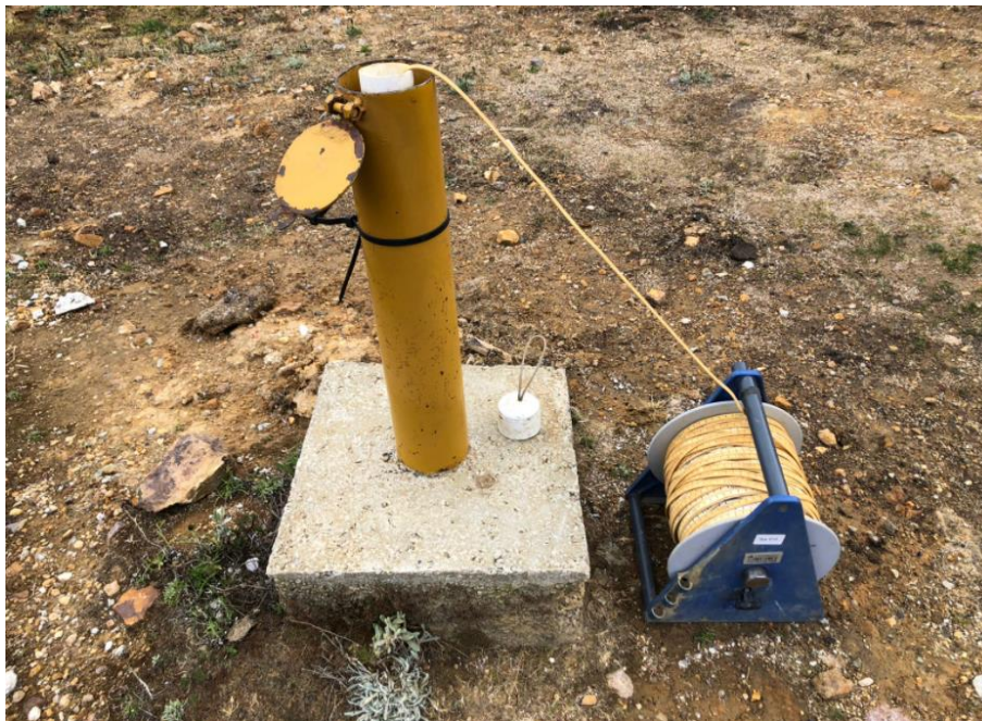
Figura 4.2 Monitoreo de piezómetros Fuente: Elaboración propia
