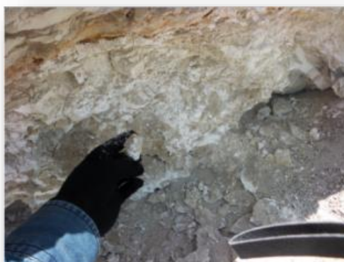
Figura 6.2 Epsomita extraída a 1.2 m de profundidad, se encuentra relleno las fracturas de la roca. Fuente: Elaboración propia
