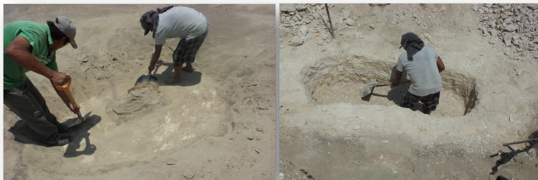
Figura 6.13 La imagen de la izquierda, inicialmente se remueve la capa de arena y desmorte. En la imagen de la derecha se excavó hasta una profundidad de 50 cm aproximadamente, donde la epsomita está presente en mayor concentración, a mayor profundidad en este caso la epsomita baja considerablemente su concentración.
