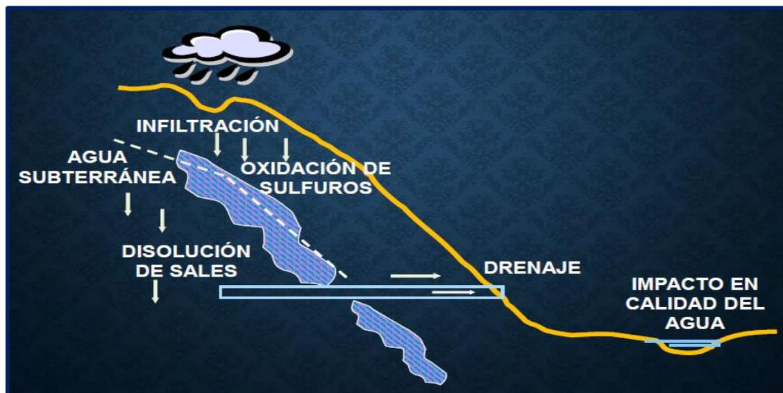
**FIGURA 1.1.: DRENAJE ACIDO EN MINA SUBTERRÁNEA**
