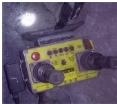
FIGURA 5.13 Control remoto CAT R1300G. Fuente: Elaboración propia.
