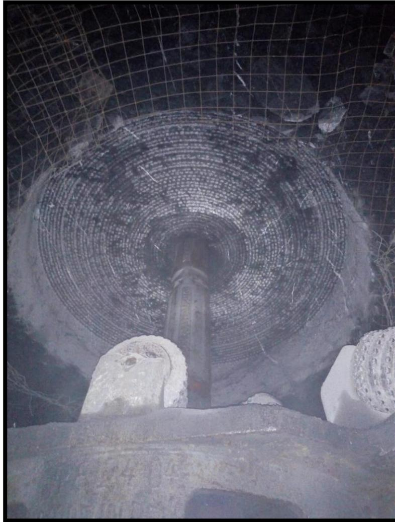
Figura 5.2 Prueba de cortadores - Maquina Raise Borer
