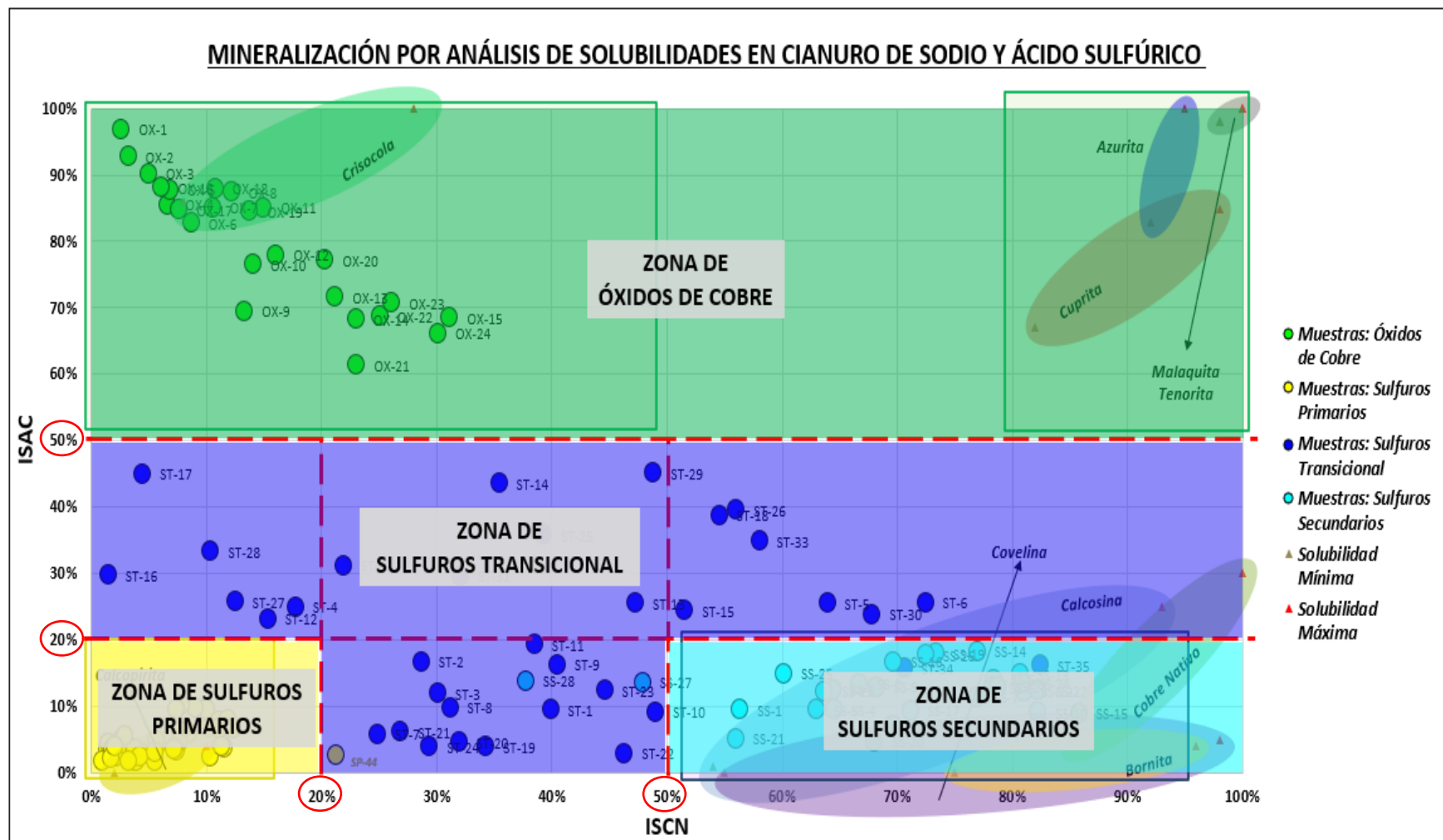
Figura 5,26 Campos y valores establecidos para mineralización de cobre en función de índices de solubilidad en cianuro de sodio y ácido sulfúrico.
