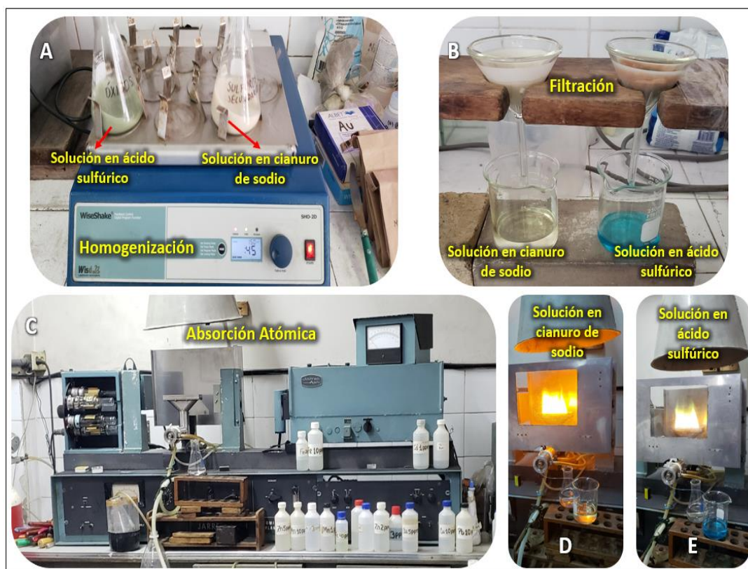
Figura 5,22 Análisis de solubilidades A) Homogenización de la solución mediante agitación mecánica. B) Filtrado de la solución. C) Equipo de absorción atómica. D) y E) Determinación del contenido de cobre soluble en ácido sulfúrico y cianuro de sodio por el método de absorción atómica.
