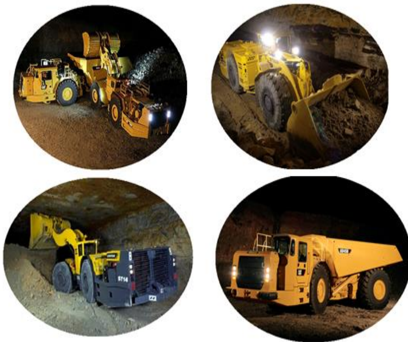
Figura 2.32 Equipos de carguío y acarreo subterráneo
