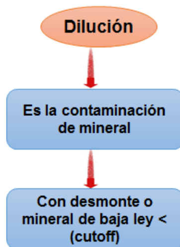
Figura 2.20 Diagrama conceptual de dilución Fuente: Elaboración propia adaptación de Hartman Mutsmanky:
