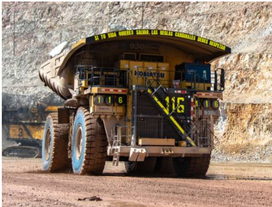
Figura 5.1: Camión de acarreo V116, Komatsu 930E-4SE. Fuente: Southern Perú, Administración Dipatch, 2021
