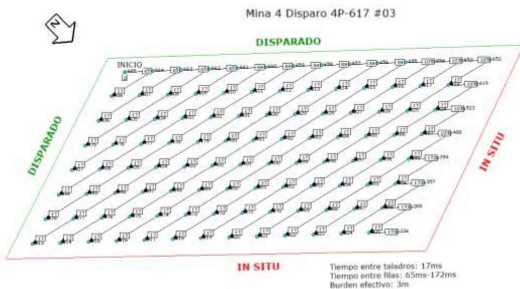
Figura 0,33 Conexión y secuencia de voladura de la Prueba 3
