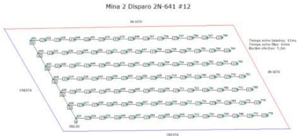
Figura 0,2 Conexión y secuencia de voladura de la Línea base 1
