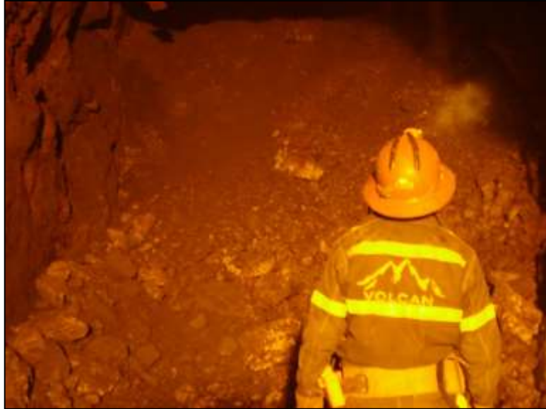
Figura 78. Fragmentación de mineral después de la voladura (Fuente: operación Mina Subterránea, EA Cerro SAC)
