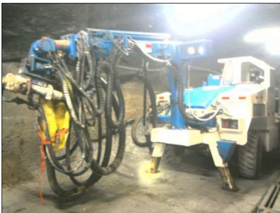
Figura 59. Robot Alfa 20, equipo mecanizado utilizado para sostenimiento (Fuente: operación Mina Subterránea, EA Cerro SAC)
