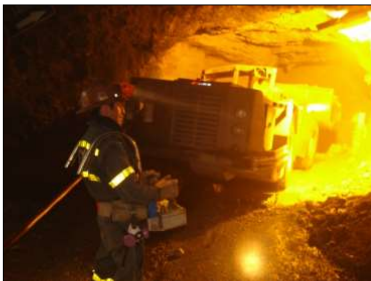
Figura 79. Limpieza a control remoto (Fuente: operación Mina Subterránea, EA Cerro SAC)
