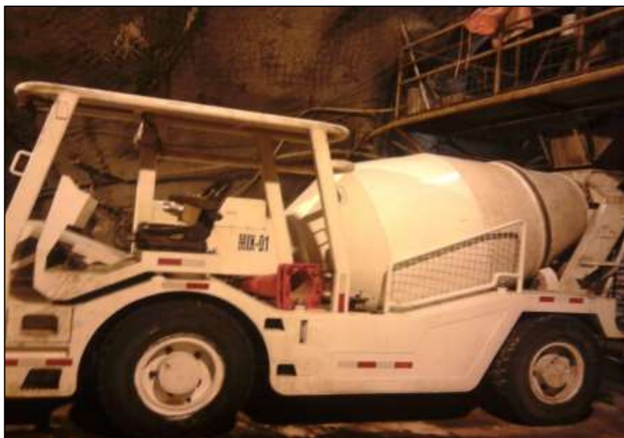
Figura 60. Mixer de 3m 3 de capacidad (Fuente: operación Mina EA Cerro SAC)
