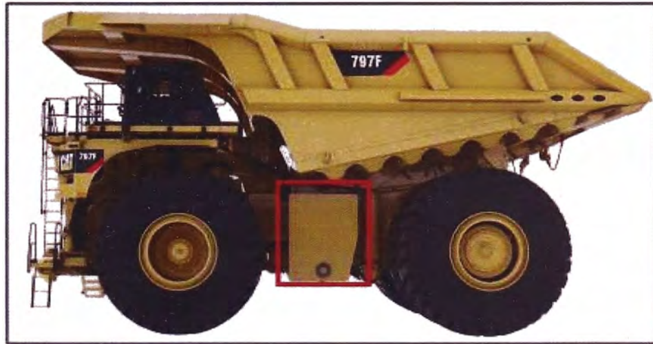
Figura 4: Ubicación del tanque de combustible.
