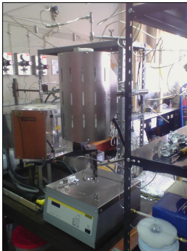
Figura 2.4. Sistema de reacción para la deshidrogenación oxidativa del etano del laboratorio de Fisicoquímica-Facultad de Ciencias-UNI.
