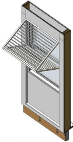
Figura 66. Diseño de alero plegable como protección de ventanas, realizado por el equipo Ayni.
