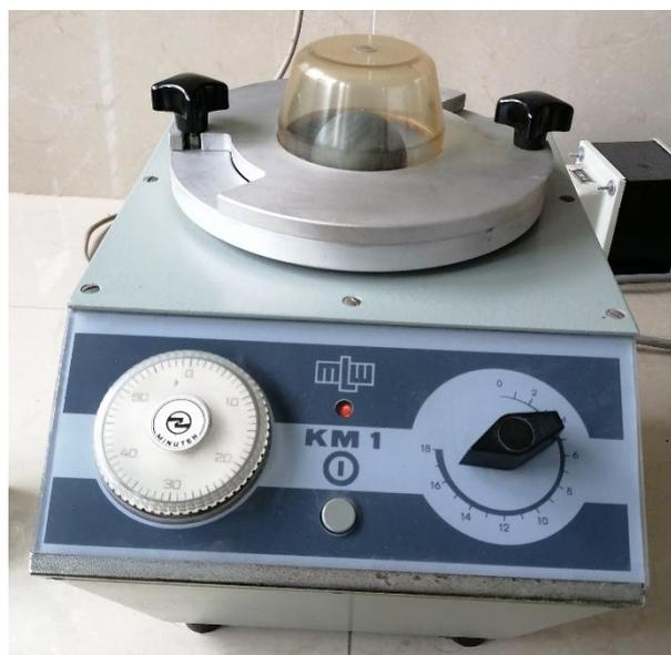
**Figura 21.** Equipo de molienda Minitem MLW km1 con cámara de ágata para síntesis mecánica.
