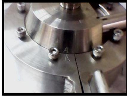
3. Colocar los ocho pernos de la tapa, ajustar con la mano, aplicar un ajuste suave con la llave de boca. El orden de ajustes es aplicando ajustes en cruz respecto al primer perno. Ajustar completo los pernos de las abrazaderas y terminar ajustando los pernos de la tapa.
