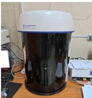
*Figura 23.* Equipo GEMINI VII 2390 de Micromeritics usado para la fisisorción de  $N_2$ .
