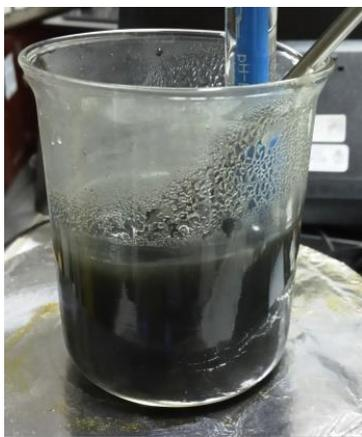
**Figura 13.** Síntesis de catalizadores por precipitación-deposición.
