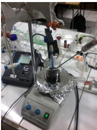
**Figura 16.** . Precipitación de precursores y adsorción con el soporte.
