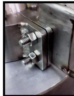
2. Colocar las abrazaderas alrededor del reactor, las abrazaderas deben coger la tapa y el borde del reactor. La orientación de las abrazaderas es tal que se debe hacer coincidir las dos letras "A" marcadas en la parte superior de ambas abrazaderas con las otras dos marcadas en la tapa. En las orejas de las abrazaderas están los orificios para los pernos, allí colocar las asas y poner los pernos con sus tuercas. Ajustar los pernos con las manos.
