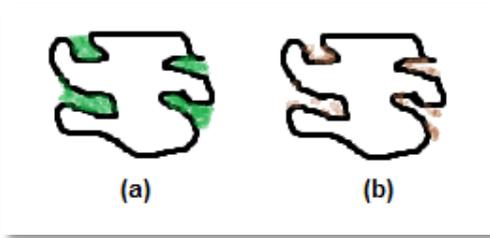
**Figura 14.** (a) Llenado de poro durante la impregnación y (b) efecto del calentamiento. Adaptado de Ross [68].
