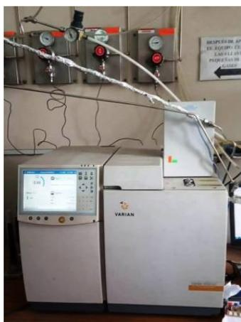
**Figura 22.** Equipo cromatógrafo de gases usado para el análisis de los productos de reacción.
