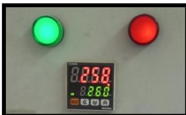
7. Terminada la reacción se pone en OFF el suministro de corriente eléctrica al calentador y se deja enfriar. Se puede ayudar aplicando un flujo de aire. Dejar bajar la presión interna del reactor. Llegada a la temperatura ambiente, desconectar la manguera de suministro de gas, abrir la válvula ligeramente, dejar que baje la presión.
