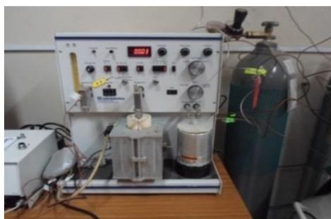
*Figura 25.* Equipo ChemiSoft TPx de Micromeritics de reducción a temperatura programada (TPR).
