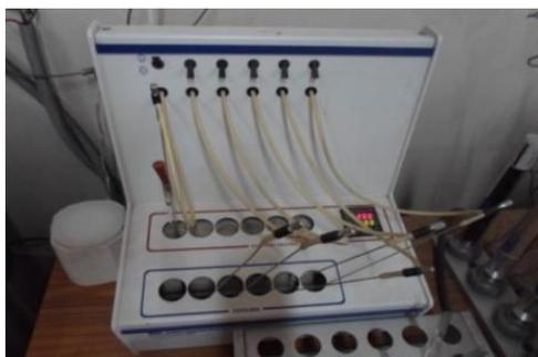
*Figura 24.* Equipo Micromeritics usado para la desgasificación en ambiente inerte.
