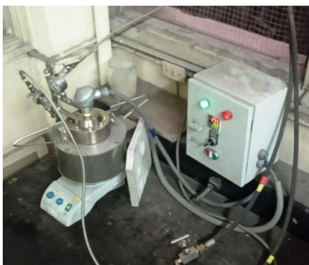
**Figura 20.** Detalle del reactor Batch para hidrogenación de palmitato de metilo.
