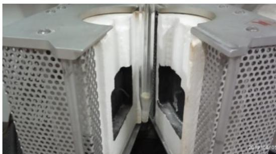
**Figura 19.** Detalle del reactor lecho fijo de vidrio usado para la activación de los catalizadores.
