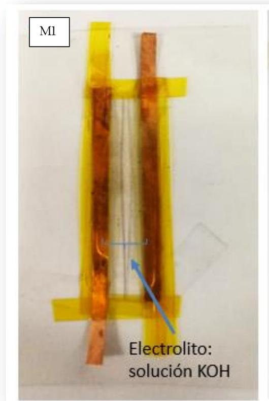
**Figura 3.10:** Figura en donde se muestra la adición de electrolito al condensador de electrodos M1.
