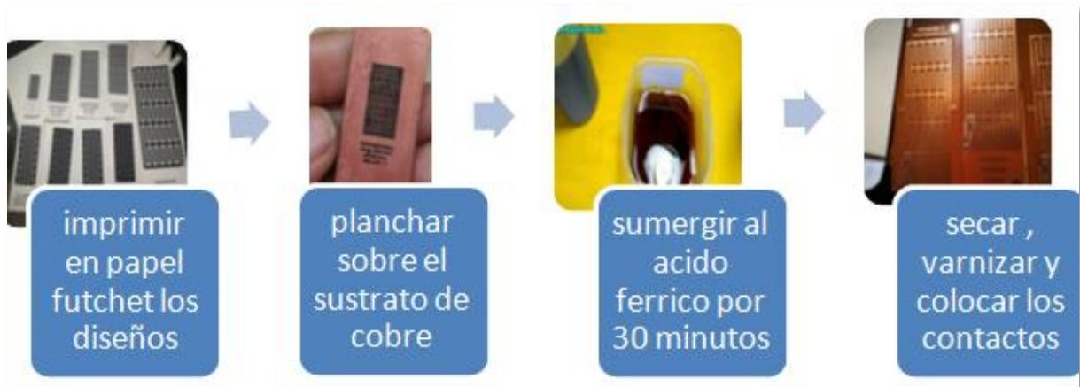
**Figura 3.3:** Proceso de grabado en cobre mediante la técnica del planchado.
