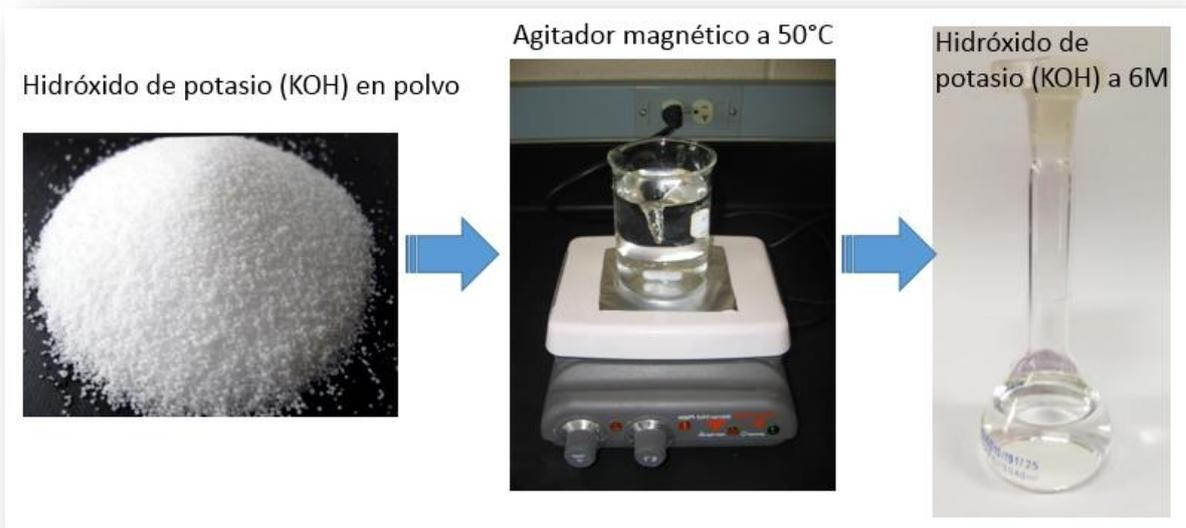
**Figura 3.1:** Procedimiento para obtener el electrolito de hidróxido de potasio (KOH) a 6M.
