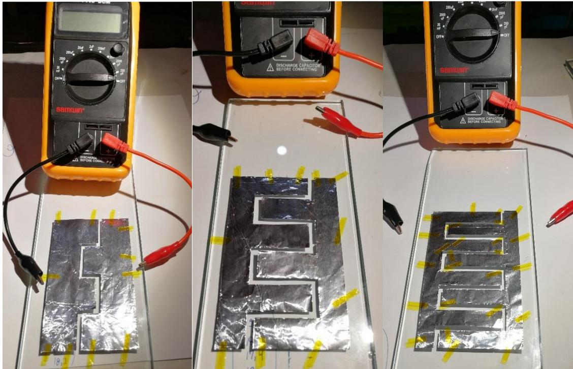
**Figura 5.8:** Diseño de un condensador interdigital de aluminio con 4, 6, y 8 “dedos”, respectivamente.
