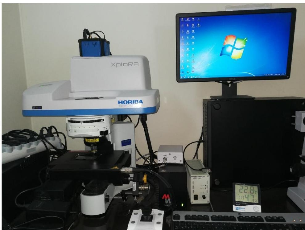
**Figura 8.1:** Equipo de espectroscopía Raman del laboratorio de electroquímica en la Facultad de ciencias de la Universidad Nacional de ingeniería (UNI).
