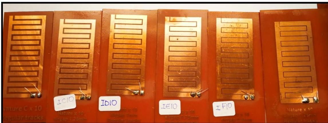
**Figura 4.4 a:** Etching de cobre de geometría interdigital con airgap variando desde 0.5 a 0.25mm.
