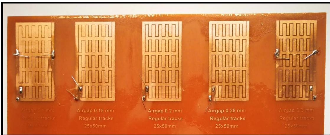
**Figura 4.5 a:** Etching de cobre de geometría modular con airgap de 0.1,0.15,0.2,0.25 y 0.3 mm.
