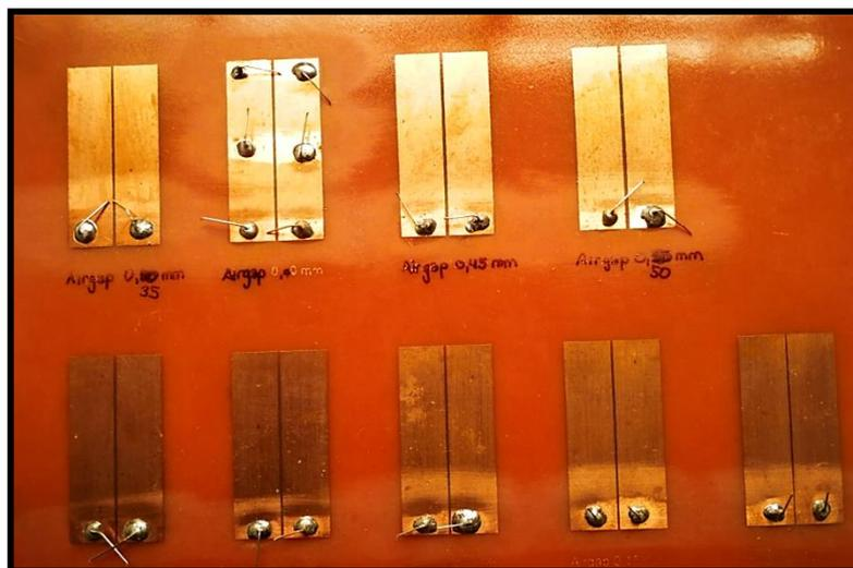
**Figura 4.3 a:** Etching de geometría de bandas a diferentes airgaps de 0.5 a 0.1 mm.
