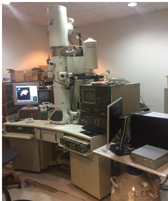
Figura 4.11: Microscopio electrónico de transmisión marca JEOL modelo JEM 2010FEG del Laboratorio de Central de Microscopía del Instituto de Física de la Universidad Nacional Autónoma de México (LCM-IFUNAM).
