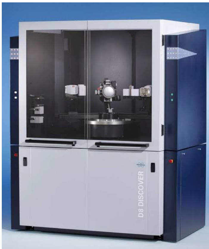
Figura 4.9: Difractómetro de rayos X marca Bruker, modelo D8 Discover utilizado en el Laboratorio de Refinamiento de Estructuras Cristalinas, LAREC-IFUNAM.
