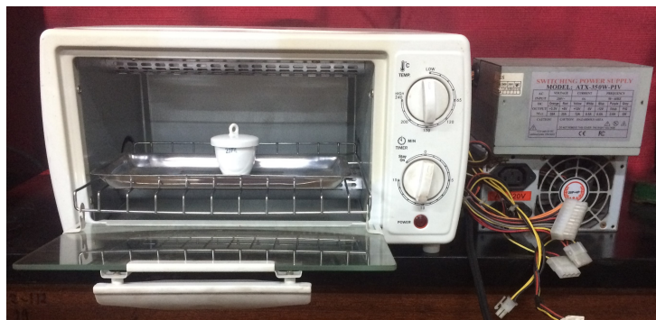
Figura 4.8: Muestra en crisol dentro de un horno eléctrico para proceso de secado .
