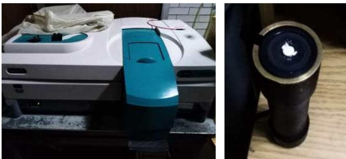
Figura 3. 16: La imagen de la izquierda es el espectrofotómetro (UV-Vis) y (NIR) marca Cary 5000, el de la derecha es la porta muestra donde se colocan las muestras empastilladas.
