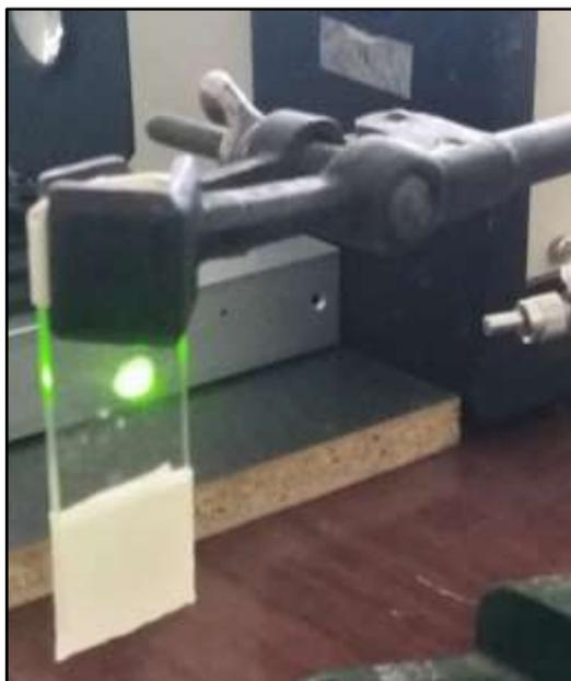
**Figura 3. 8: Muestra del tratamiento térmico de 600 °C con un tiempo de 5 horas, de la síntesis del NaYF<sub>4</sub>: Yb<sup>3+</sup>, Ho<sup>3+</sup>.**
