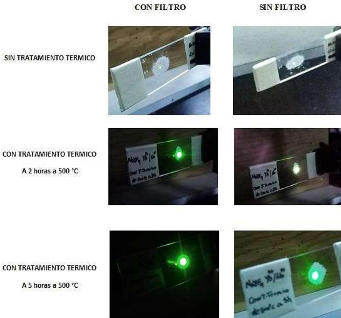
**Figura 3. 7: Comparación a simple vista, de muestras con tratamientos térmicos y sin tratamiento térmico.**
