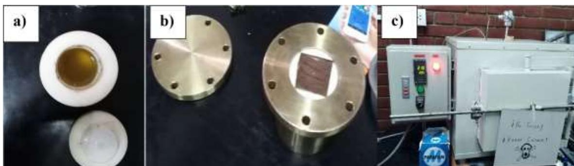
**Figura 2. 1: Proceso solvotermal: a) teflón, b)autoclave, c) horno donde se realizó la síntesis, modelo EUROTHEM 2408 F.**
