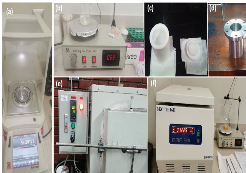
Figura 6.2: Equipos utilizados en la síntesis del material, (a) Balanza electrónica de precisión, (b) Agitador magnético, (c) Cápsula de teflón, (d) Autoclave, (e) Horno, (f) Centrifugadora.
