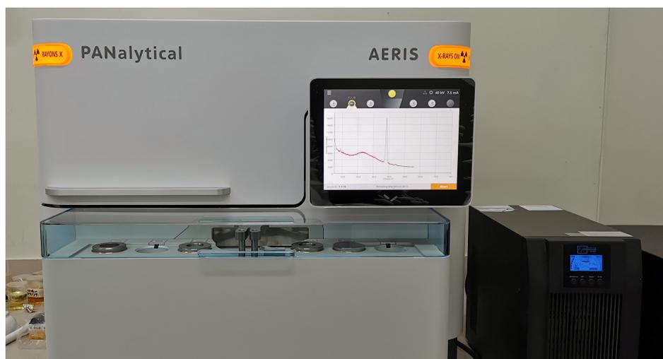
Figura 6.5: Difractómetro PANalytical, modelo AERYS.
