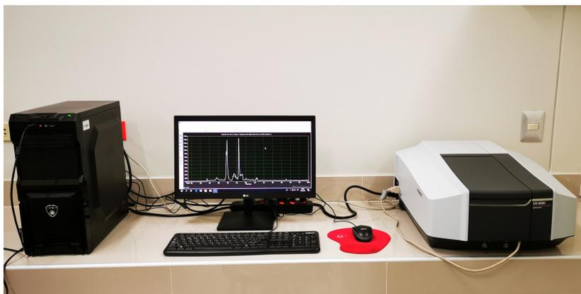
Figura 6.10: Espectrofotómetro SHIMADZU UV-2600 utilizado en la toma de espectros de absorción.
