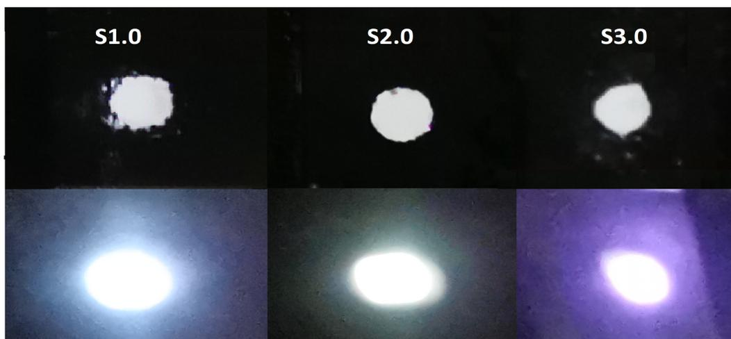
Figura 6.4: Material sintetizado y sus emisiones al ser excitado con láser IR de 980 nm. y 0.8 W de potencia.
