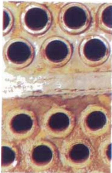
(B).- Misma placa de la figura 1.7.4A pero dividida arriba y debajo de la caja de agua para mostrar la placa de salida limpia (parte superior) y la placa de entrada con biopelícula (parte inferior)
