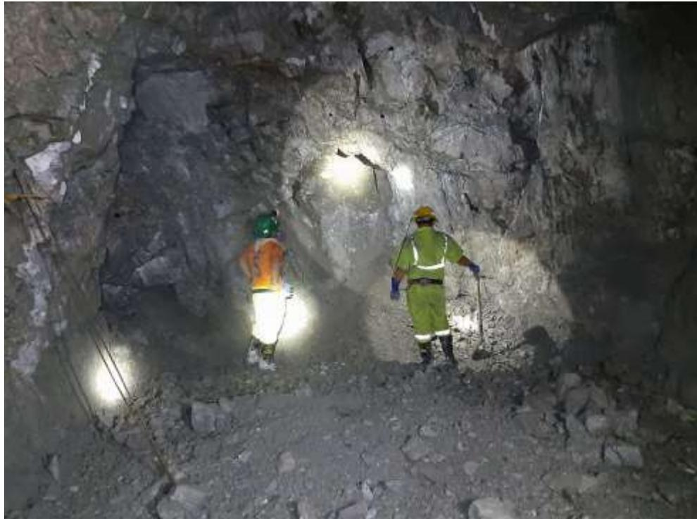
Figura 5.3. Voladura deficiente
