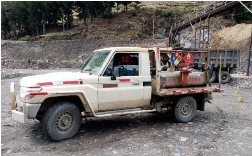
Figura 4.31: Operador de utilitario para el abastecimiento de combustible. Fuente: Elaboración propia
