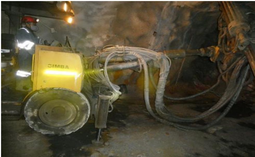
Figura 4.33: Operación del equipo simba en la perforación de taladros largos. Fuente: Elaboración propia.
