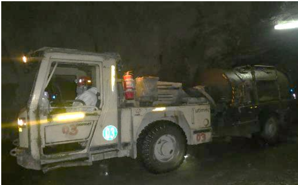
Figura 4.13: Equipo Mixer trasladando mezcla de concreto para las labores. Fuente: Elaboración propia
