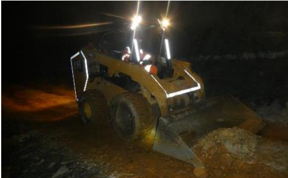
Figura 4.37: Operador de minicargador realizando la limpieza y mantenimiento de las vías en mina interior.
