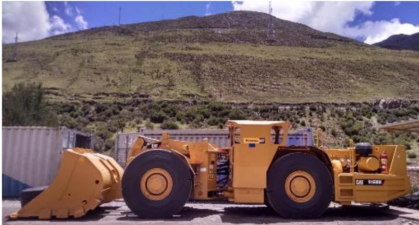
Figura 1.11. Equipo scoopteam – marca Caterpillar Fuente: Elaboración propia
