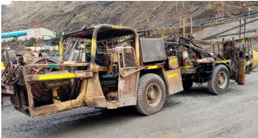
Figura 1.10. Equipo Anfotruck – marca Normet.
