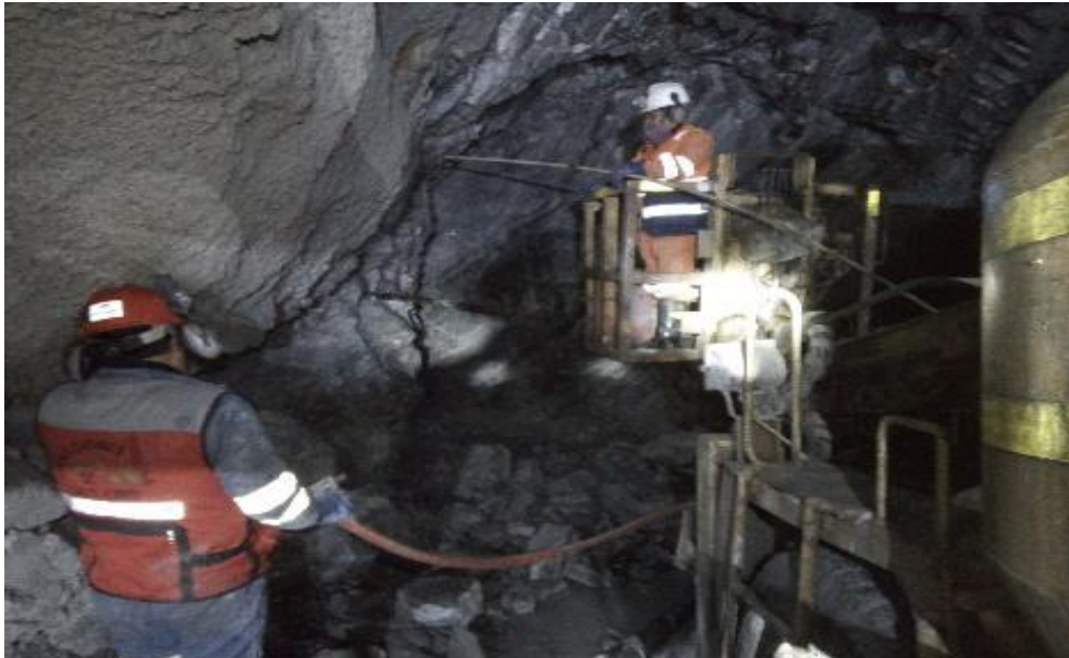
Figura 4.7: Carguío del frente de mineral (breasting) sobre la canastilla del equipo anfotruck.
