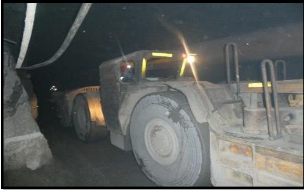
Figura 4.3: Operación de scoop en mina interior Fuente: Elaboración propia
