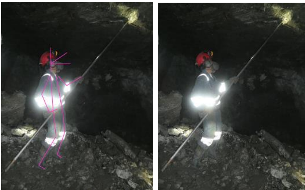
Figura 4.28: Postura adoptada por el desatador de rocas durante su actividad. Fuente: Elaboración propia
