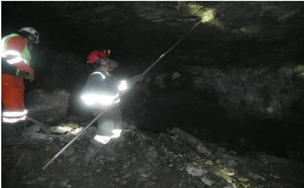
Figura 4.27: Personal de mina realizando la actividad de desate de rocas. Fuente: Elaboración propia
