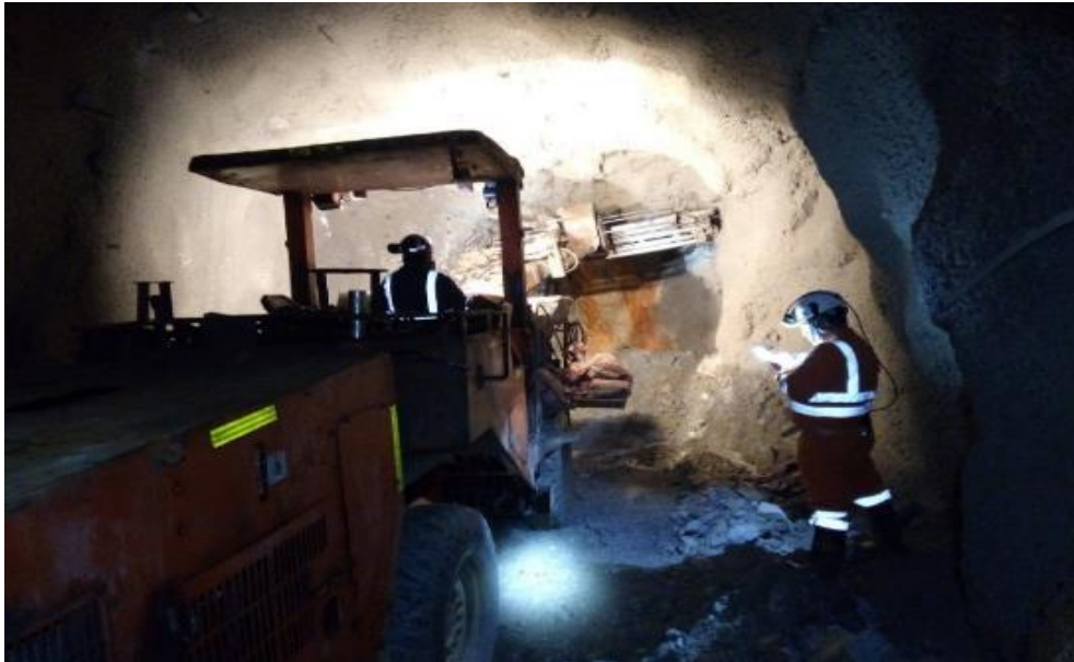
Figura 4.11: Operación sostenimiento de las labores con el equipo robot. Fuente: Elaboración propia
