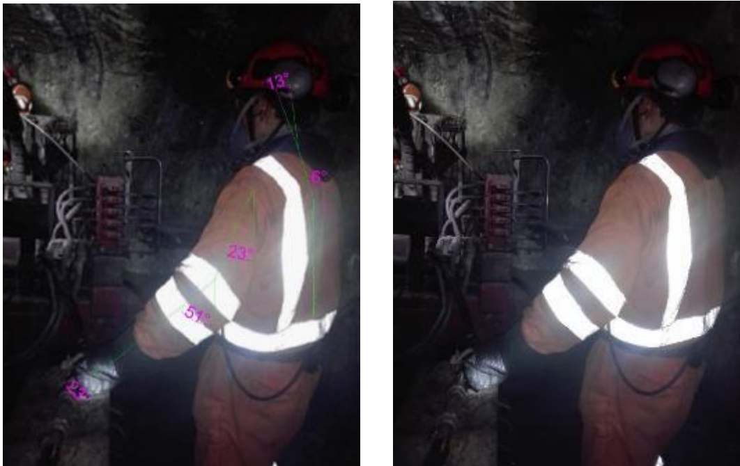
Figura 4.10: Operación del sistema de mandos del equipo anfotruck en el carguío de las labores para la voladura.
