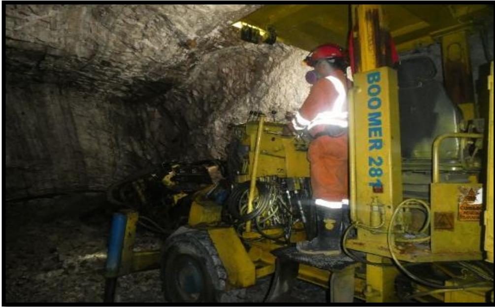
Figura 4.5: perforación de breasting en equipo jumbo. Fuente: Elaboración propia
