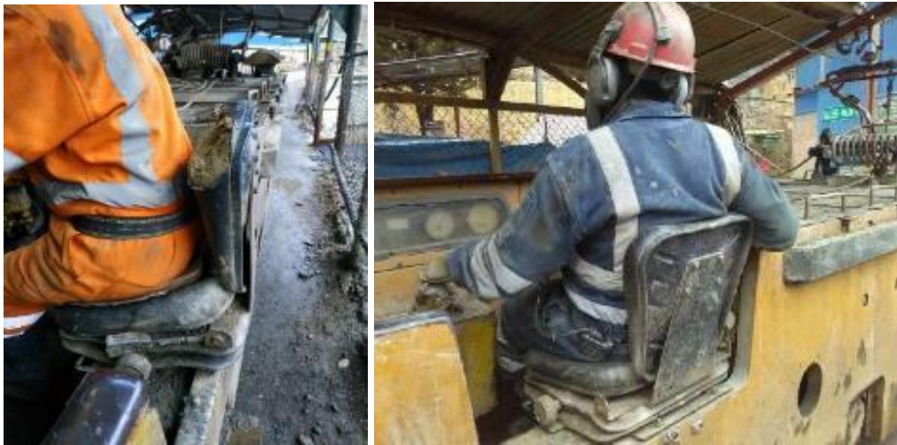
Figura R.4: asientos inadecuados que deben ser cambiado. Fuente: Elaboración propia.
