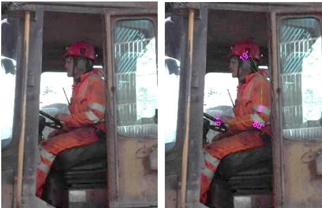
Figura 4.36: Postura adoptada por el operador cargador frontal durante el abastecimiento de mineral en el Nv 3810. Fuente: Elaboración propia.
