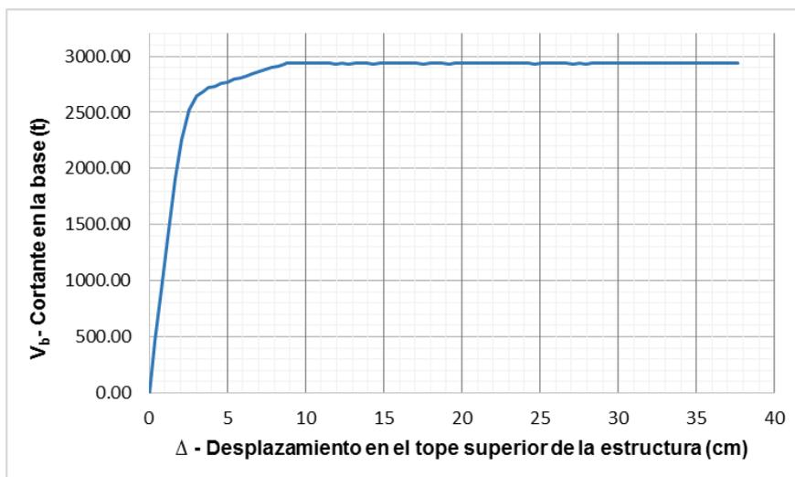
Figura N° 4.21: Curva de capacidad para el análisis en la dirección longitudinal (dirección eje “Y”).
