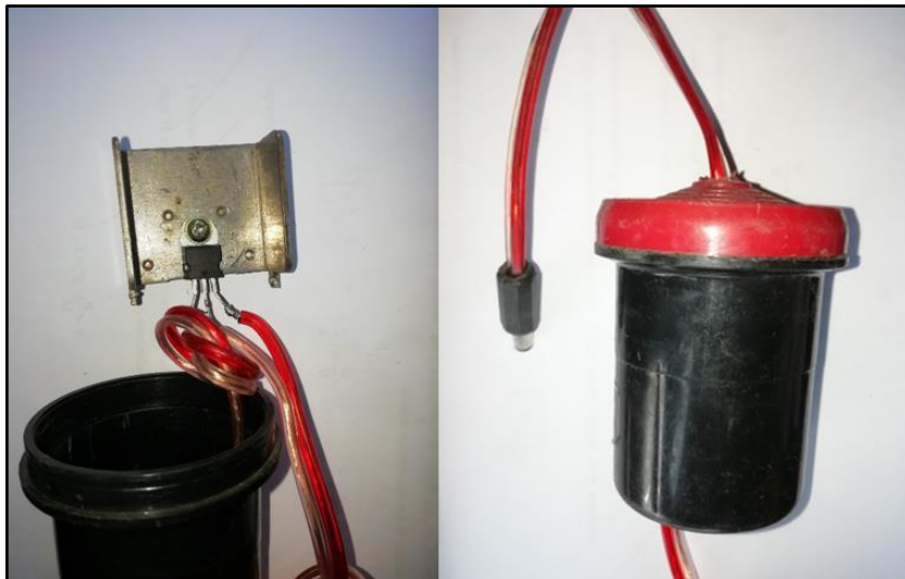
Figura N°3.4: Regulador de voltaje y recipiente protector. Fuente: Elaboración propia.
