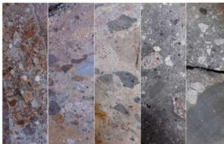
Figura 3.25 Brechas Freatomagmáticas de sondajes de Pompeya y Catalina Target.
