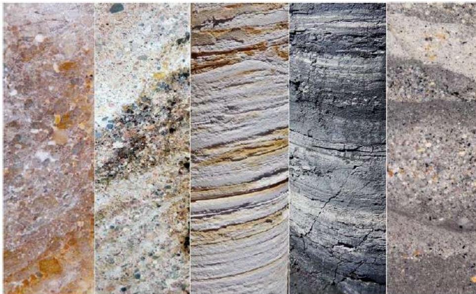
Figura 3.22 Secuencia Volcanoclastica de Catalina y de Puren. Se observa fuerte alteración de Kaolinita en la matriz intercalado con material carbonoso.
