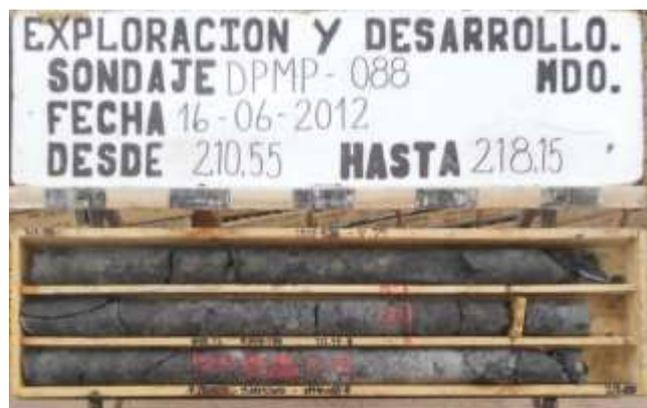
Figura 3.27 Brecha hidrotermal rellena de sulfuros masivos Pirita+Enargita+Pirofilita. Fuente: Foto supervisor de Testigoteca.
