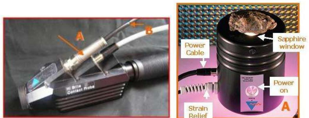
Figura 2 (a) lámpara de contacto; (b) lámpara fija.
