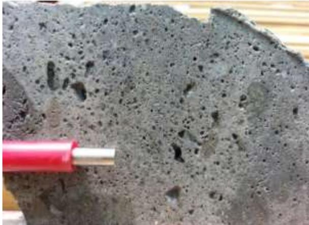
Figura 3.32 Alteración Vuggy Silica: sondaje DPMP-091 tramo 231,4-231,5 m. La alteración afecta a clastos y matriz de una roca probablemente correspondiente a la Brecha Freatomagmatica con textura fragmental original. Las oquedades tienen forma irregular y algunas están rellenas con pirita.
