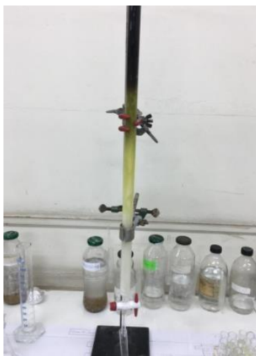
Figura 39. CC de sílica gel de \text{CH}_2\text{Cl}_2 . (Foto tomada por L. Rojas en 2019)
