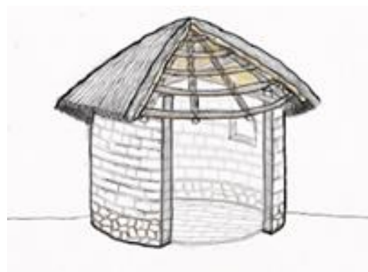
Detalle de la estructura de madera de eucalipto
