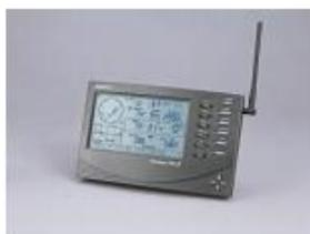
**CONSOLA:** Tiene la función de recibir teleméricamente los datos recolectados por el ISS, para almacenarlos ( en el datalogger) y procesarlos.
