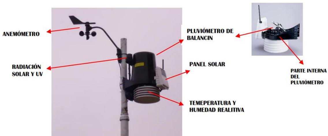
**Fig. 44.** Partes de la estación Vantage Pro 2 Plus [69].
