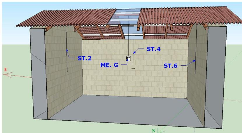
**Fig. 47.** Vista interior de la ubicación de los ST. y micro estación ubicados en el interior del módulo mejorado.
