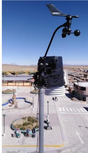
**Fig. 43.** Estación Davis instalada en la azotea de la municipalidad de Imata.
