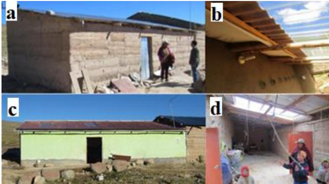
**Fig. 8.** Antes y después de los cambios realizados en las viviendas: (a) vivienda ubicada en el centro poblado de San Felipe, antes de las mejoras, (b) invernadero adosado a la vivienda, (c) vista exterior de la vivienda después de las mejoras, y (d) vista en el interior de las claraboyas en el techo [18].
