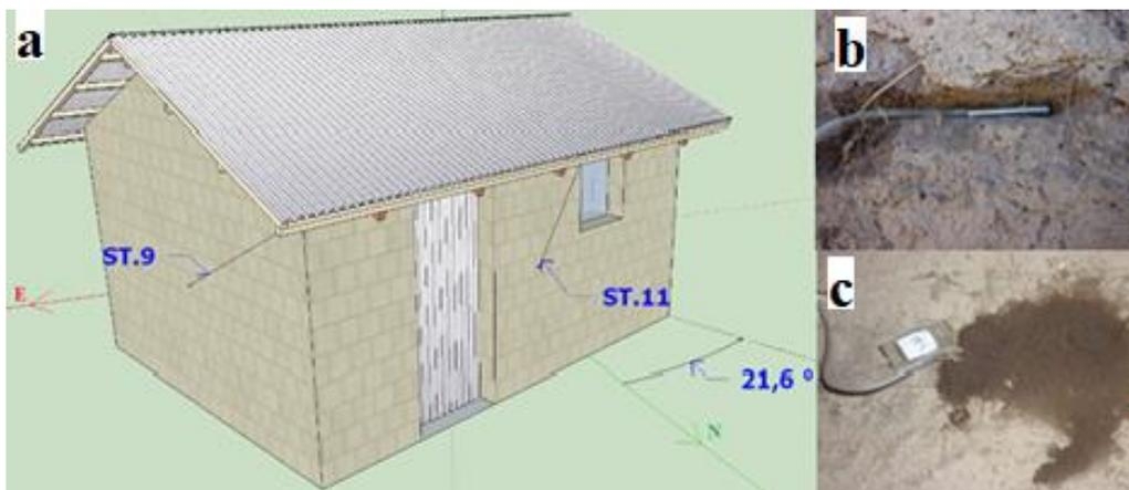
**Fig. 45.** Ubicación de sensores en el MEV: (a) vista exterior de sensores de temperatura empotrados en las paredes, (b) sensor ubicado en la pared de adobe, y (c) sensor empotrado en la pared de adobe.
