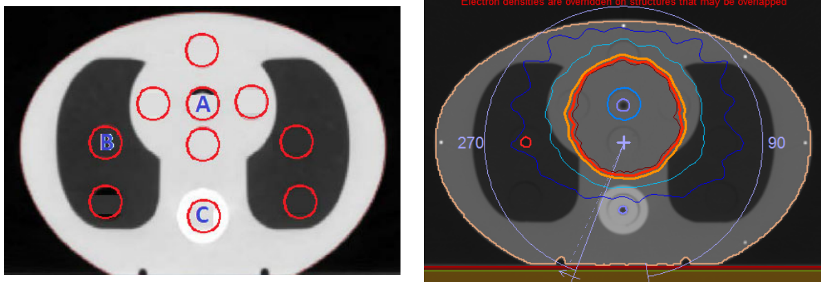
Figura 22. Imagen de posiciones de las cámaras en la prueba de medición de dosis absoluta de un cilindro grande en una zona de tejido equivalente a agua.
