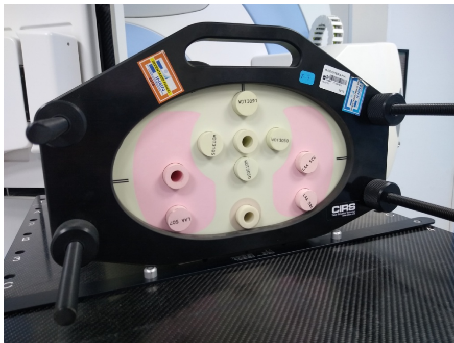
Figura 6. Fantoma heterogéneo de tórax Cirs con diferentes densidades electrónicas e insertos de cámaras de ionización.
