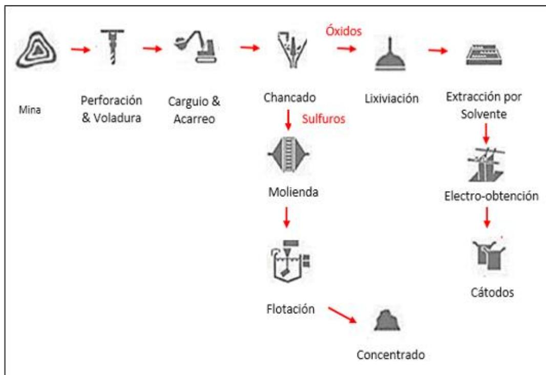
Figura 2.1 Proceso típico productivo de una mina a tajo abierto
