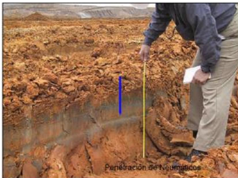
Figura 2.13 Medición de penetración de ruedas en vía con alta resistencia a la rodadura
