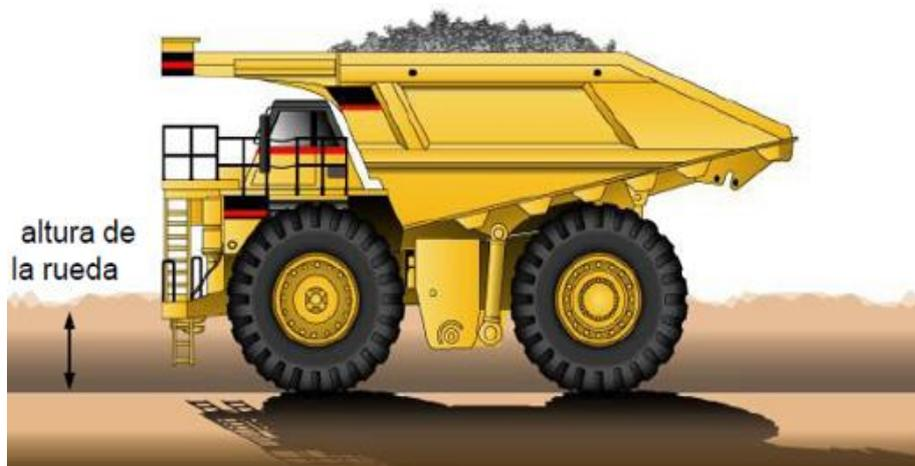
Figura 2.14 Diseño de altura de berma  $\frac{3}{4}$  de llanta más alta
