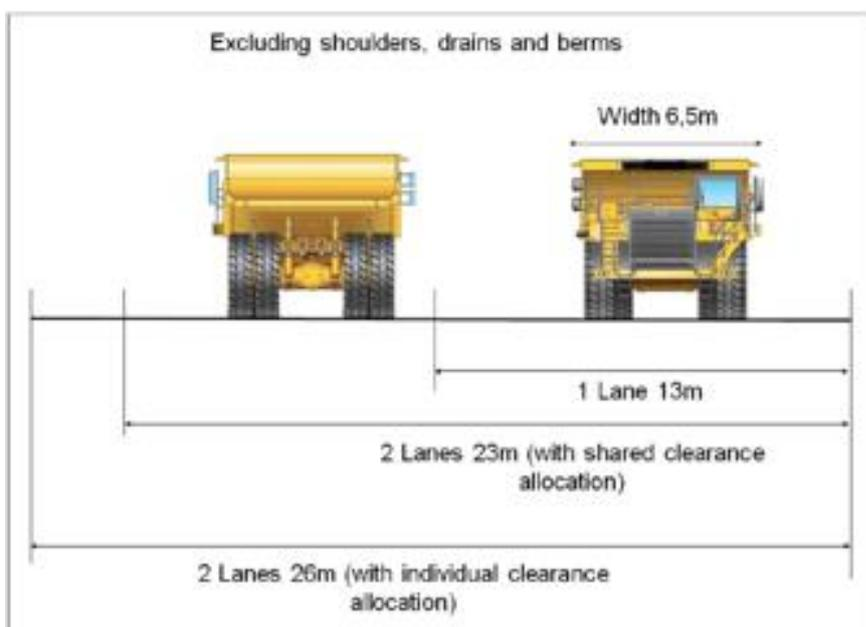
Figura 2.15 Diseño de ancho de vía con espaciamento a los lados sin incluir bermas y drenajes
