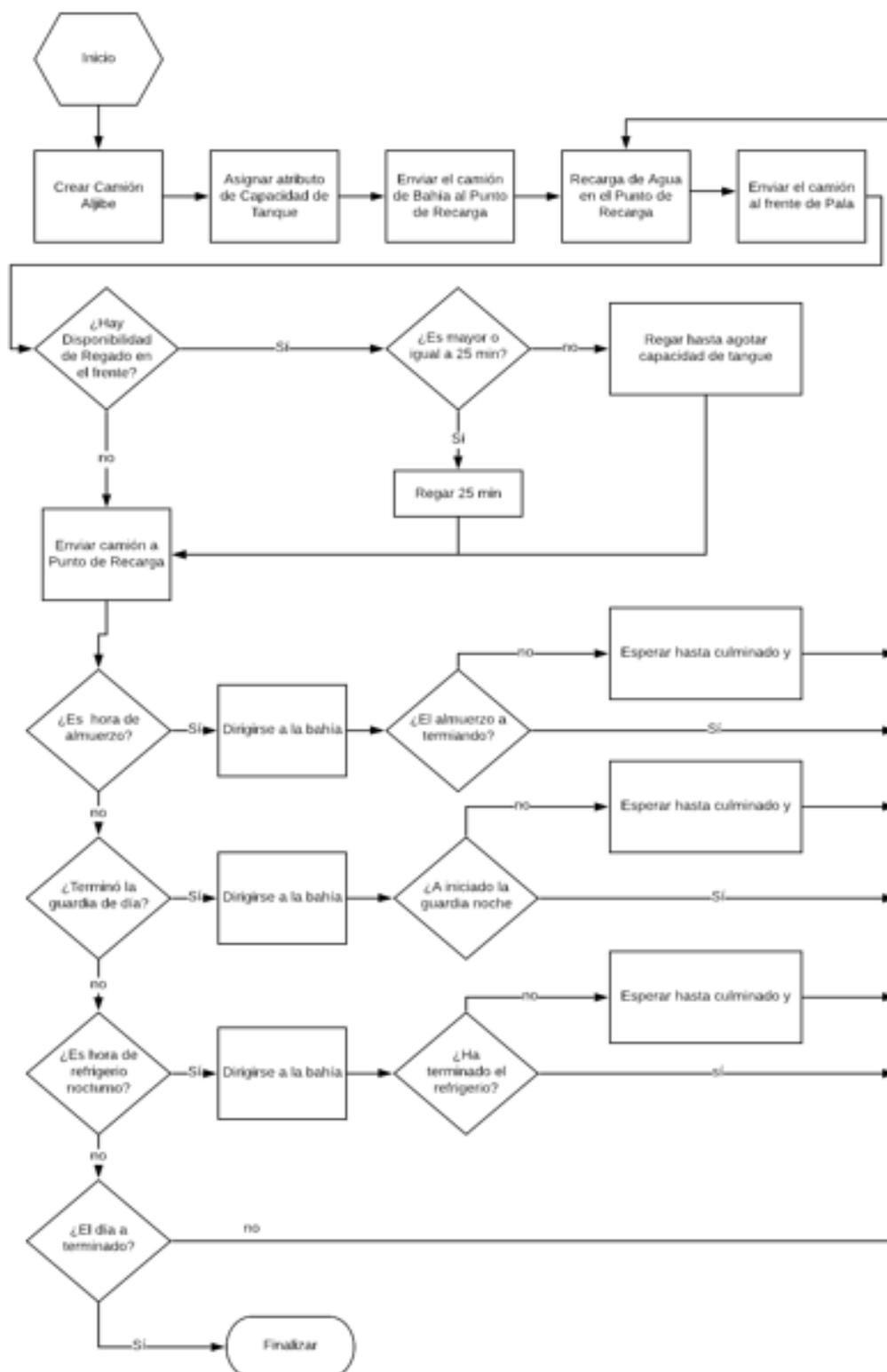
Figura 4.1 Formulación del modelo conceptual del sistema de riego de una mina a tajo abierto
