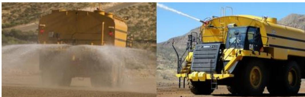
Figura 2.22 Aspersores en la parte inferior trasera y cañón de agua en la parte superior delantera del camión regador
