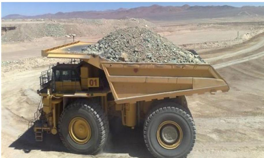
Figura 2.20. Carguío de material fragmentado
