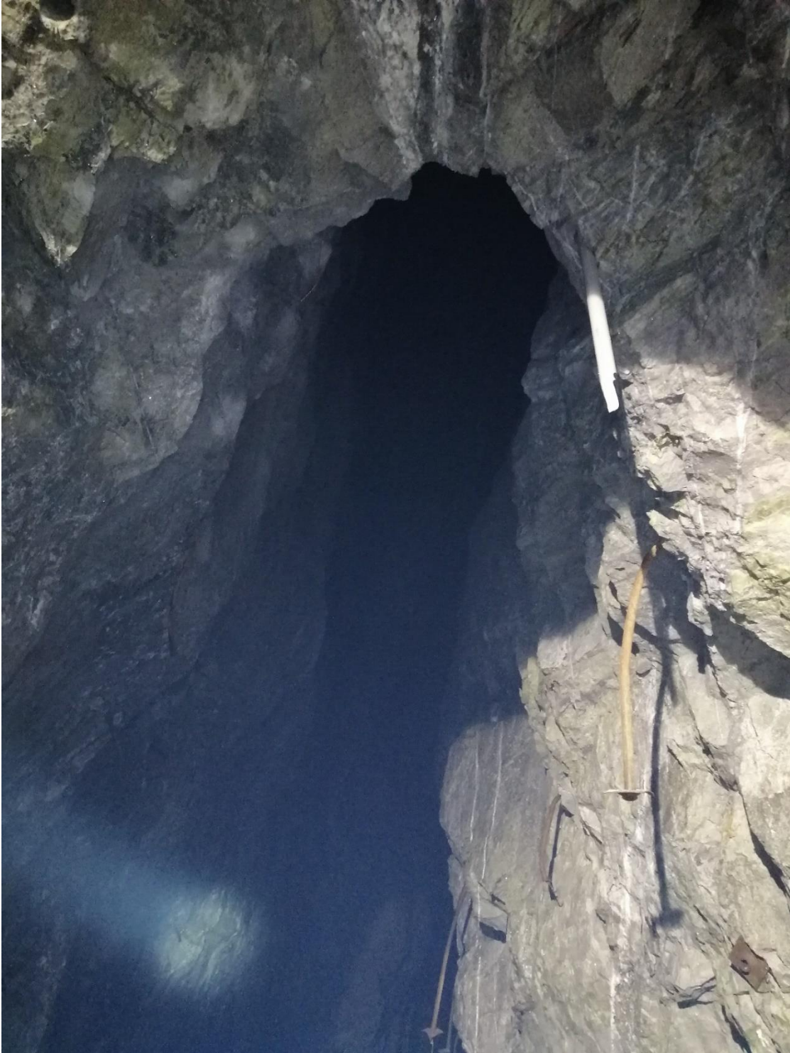
Figura E.2. Veta angosta y tajeo en producción
