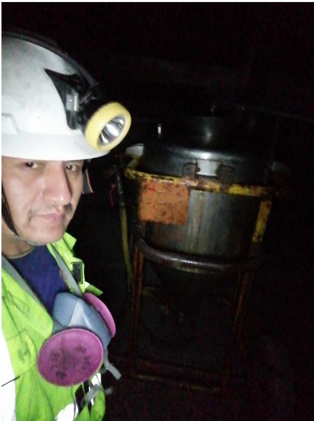
Figura E.7. Anfocar, equipo para el carguío de taladros largos
