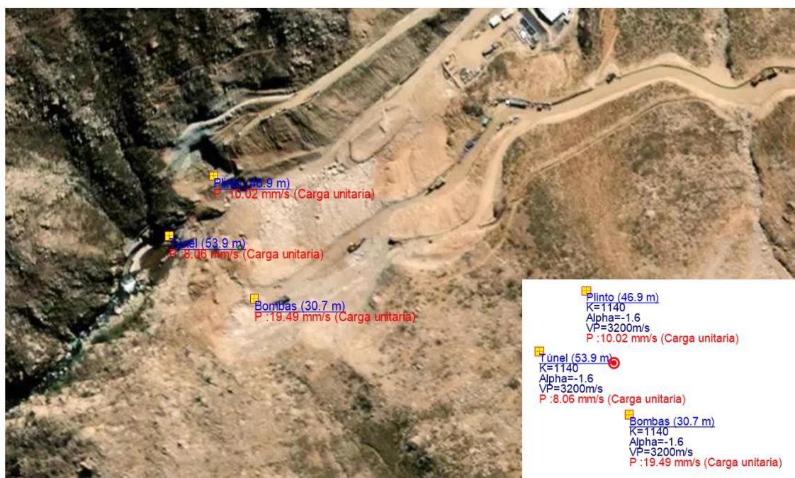
**Figura 3.10. Simulación de VPP para modelo de carga N°3.**
