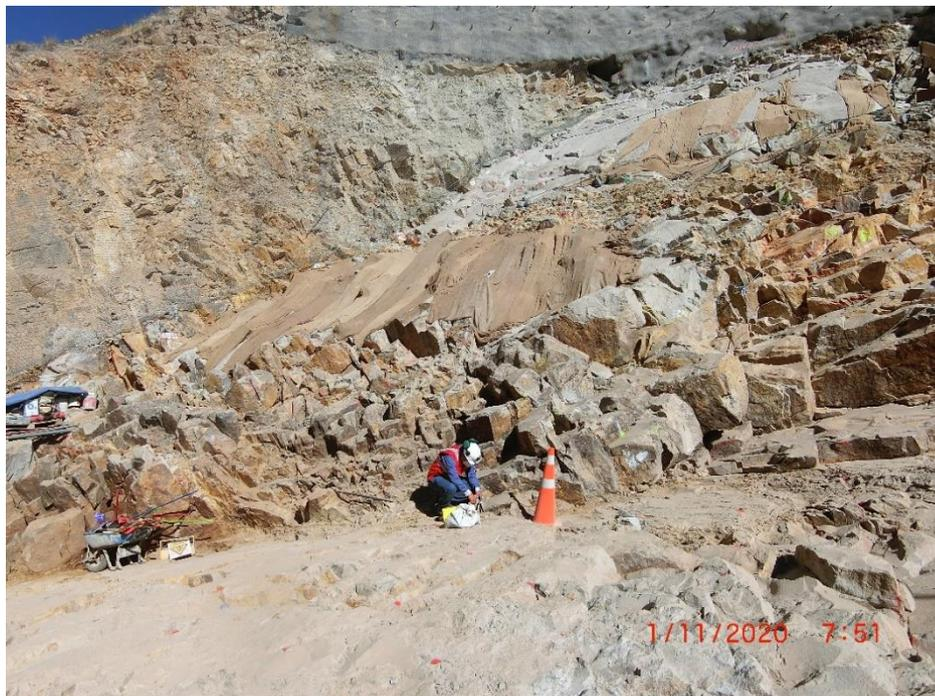
**Figura 2:** *Colocación de sismógrafo en punto de monitoreo zona Plinto.*
