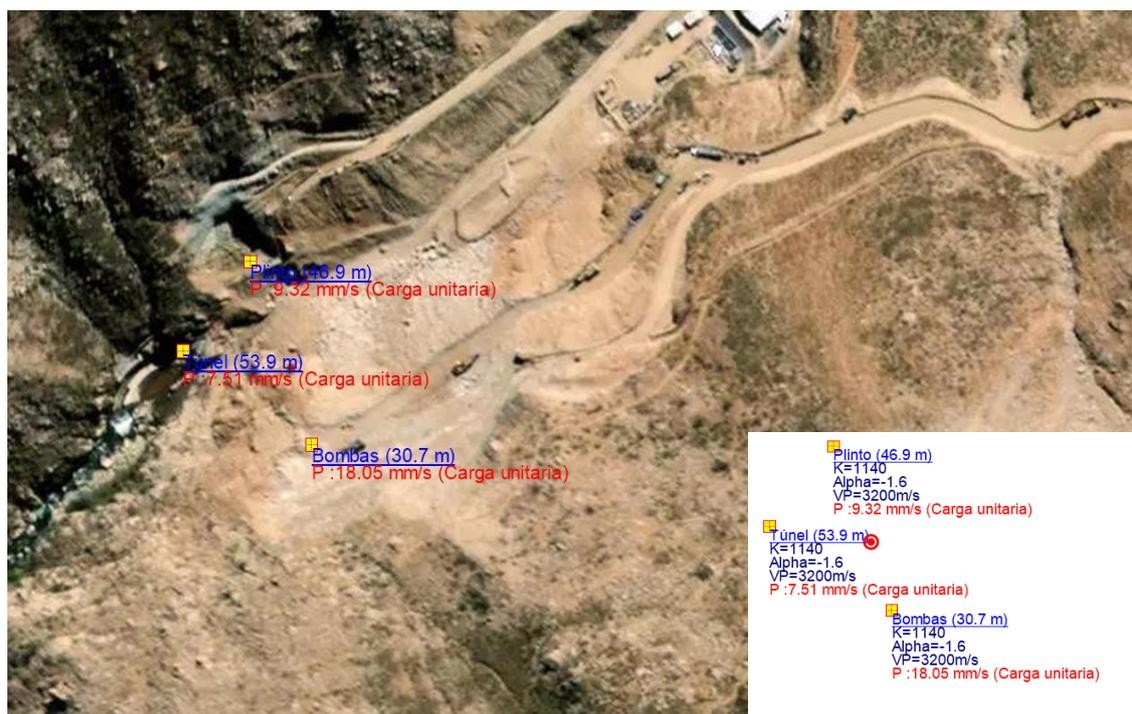
**Figura 3.8. Simulación de VPP para modelo de carga N°1.**
