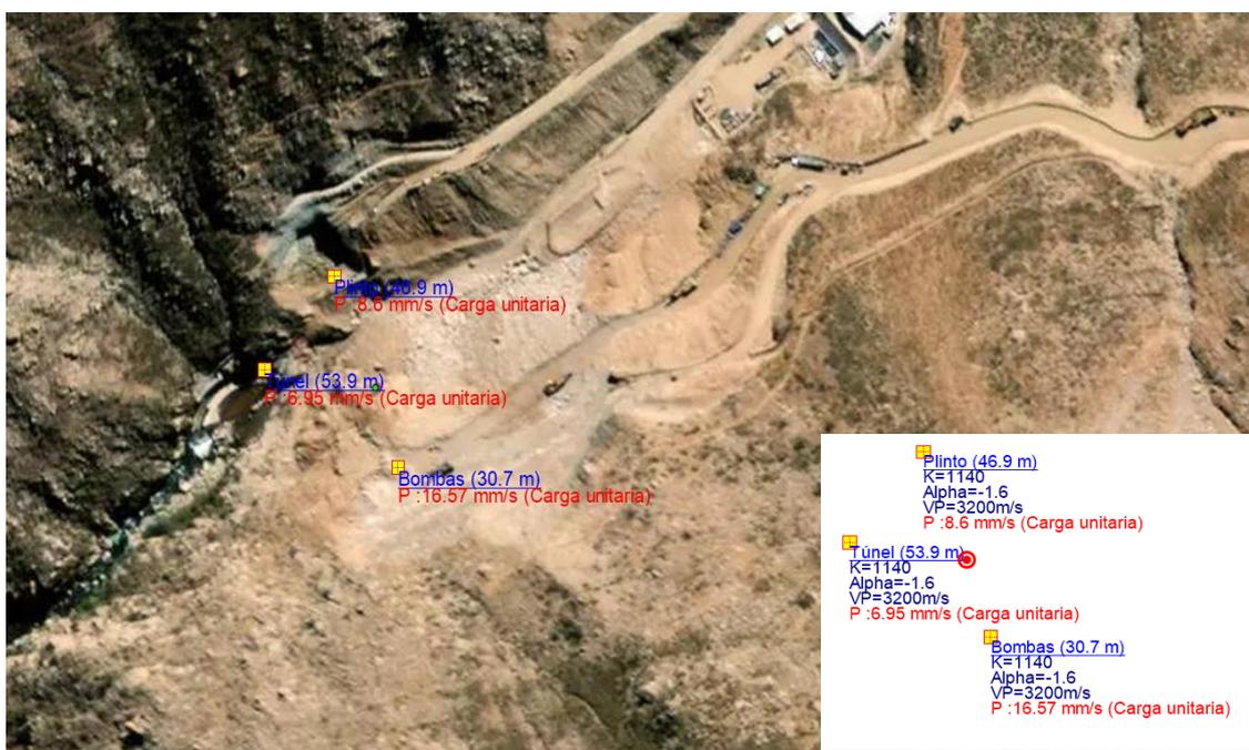
**Figura 3.9. Simulación de VPP para modelo de carga N°2.**
