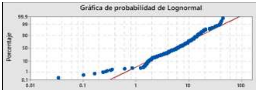
Figura 5.10: Probabilidad lognormal del tiempo de descarga en C22 (Escenario 1)
