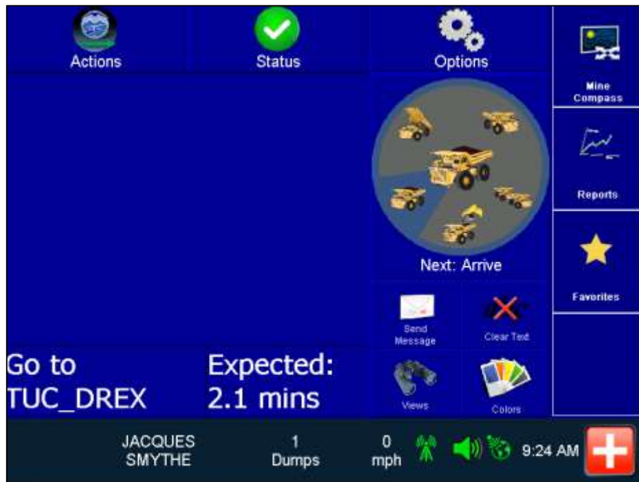
Figura 2.15: Camión cargado con asignación a punto de descarga visualizado desde el PTX del camión.
