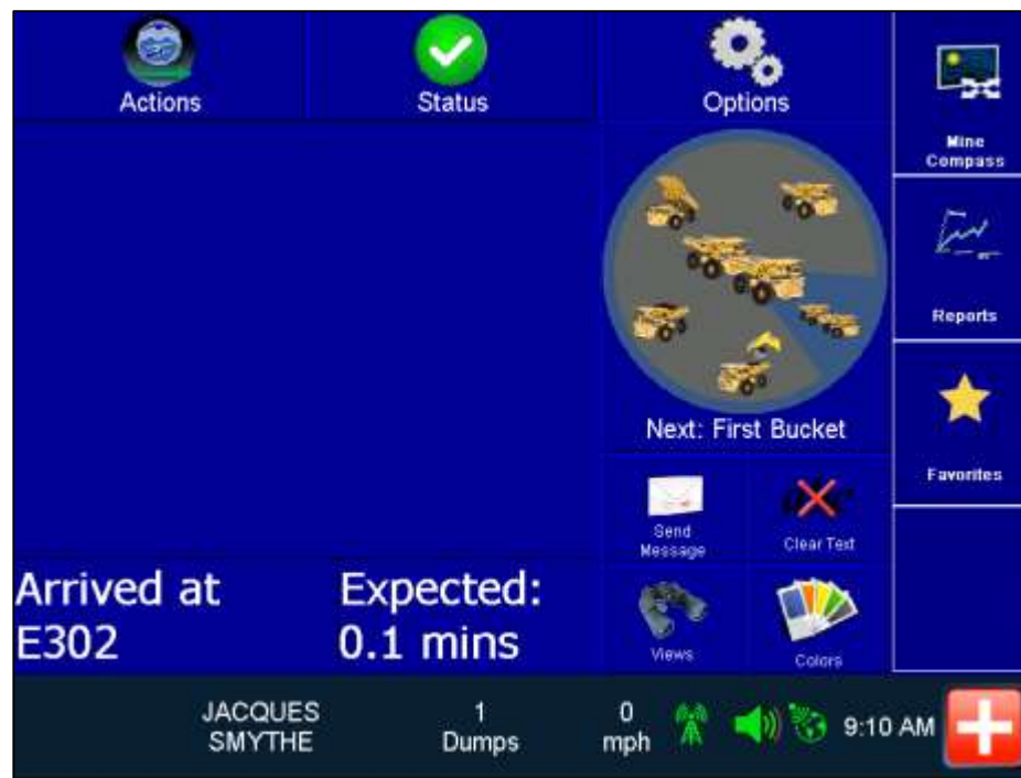
Figura 2.11: Camión con llegada visualizada en la pantalla PTX del camión.
