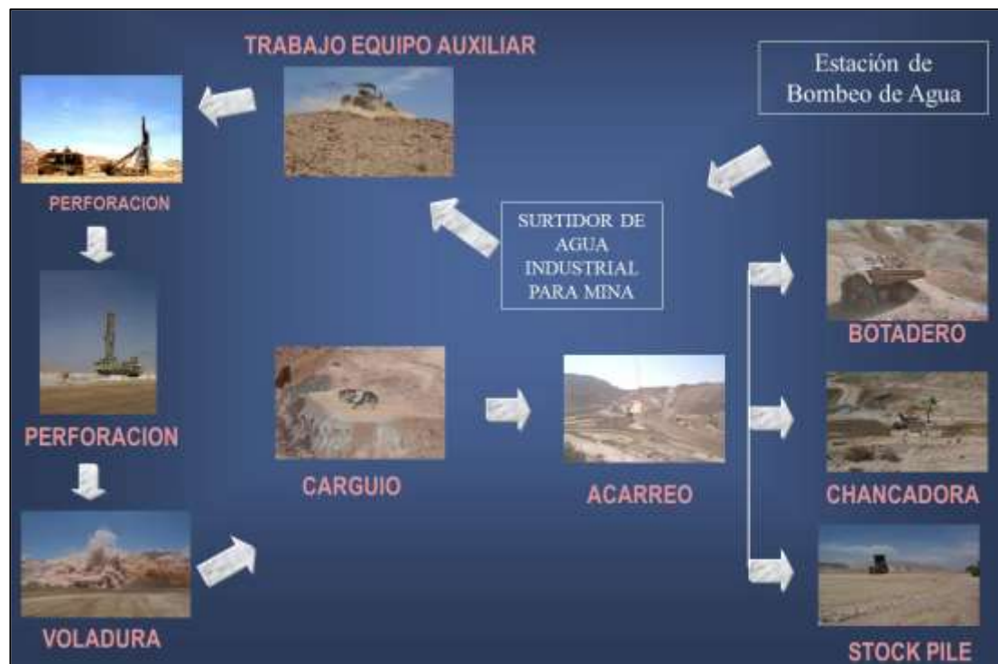
Figura 2.1: Esquema de las operaciones mineras unitarias
