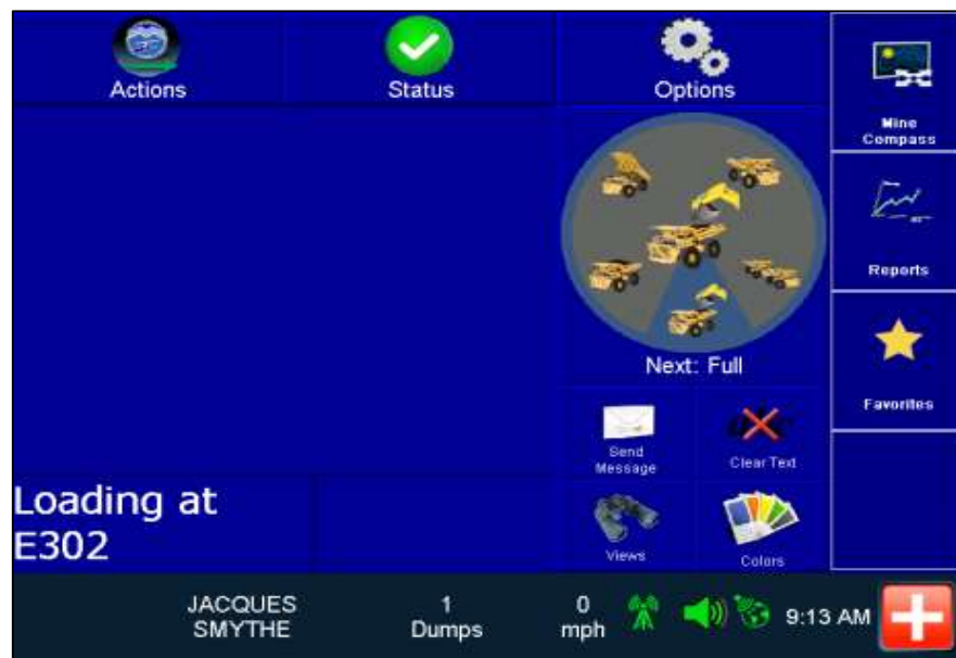
Figura 2.12: Camión cargando visualizada en la pantalla PTX del camión.
