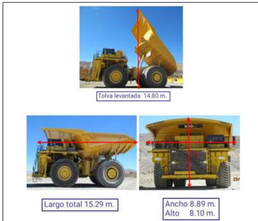
Figura 2.9: Dimensiones Camión Komatsu 930 E
