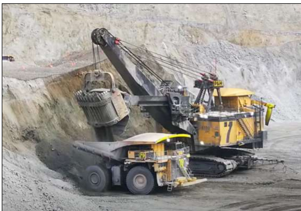
Figura 2.2: Operación Unitaria de Carguío
