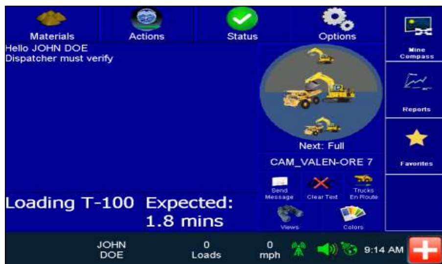
Figura 2.13: Camión cargando visualizada en la pantalla PTX de la Pala.
