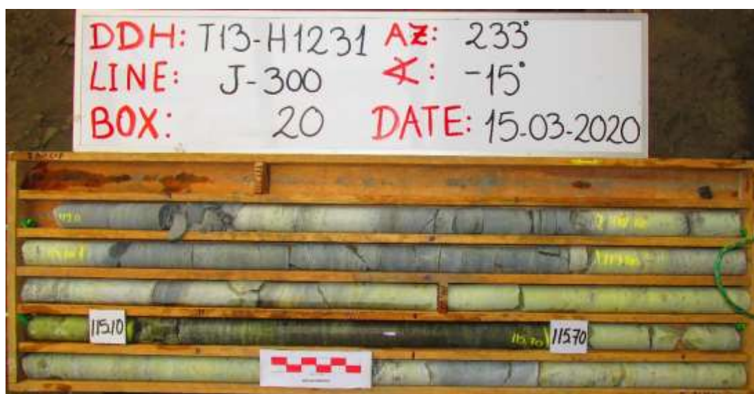
Figura 4.3: Fotografía del tramo de muestreo en sondaje BQ
