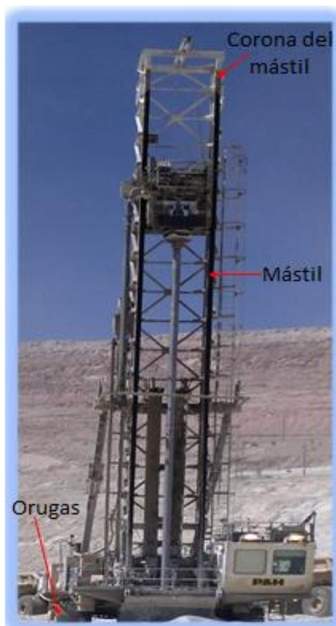
Figura N° 0-7: Partes de la perforadora general
