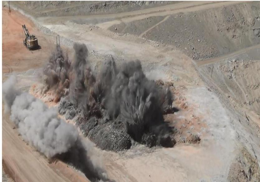
Figura N° 0-11: Voladura de un banco
