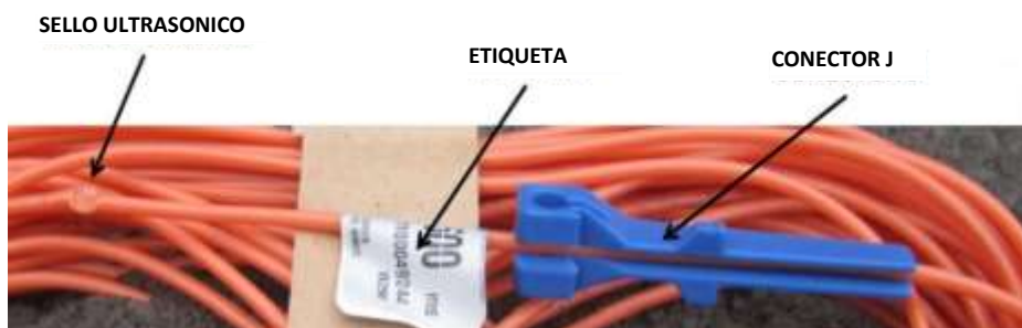
Figura 5 Detalle de los elementos del Exel 600 ms
