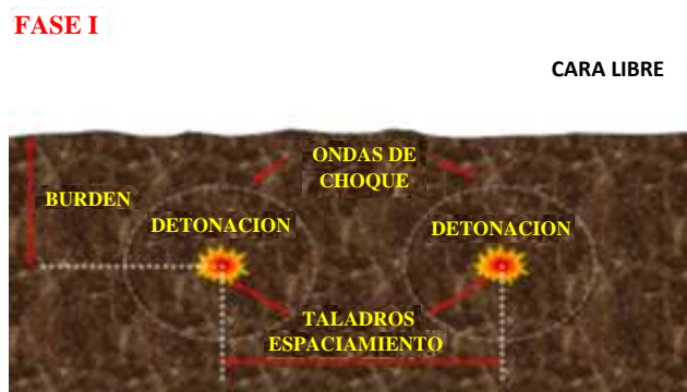
Figura 22 Proceso de detonación de los taladros
