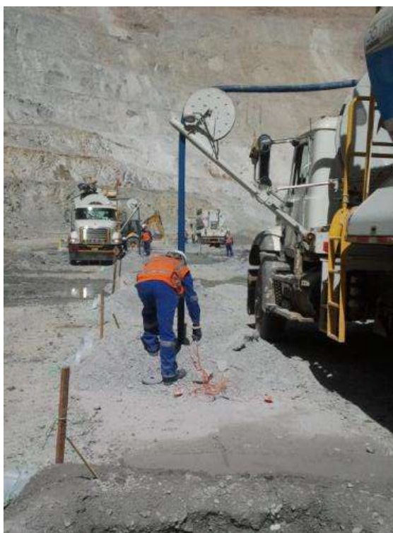
Figura 34 Primado y carguío de taladros.
