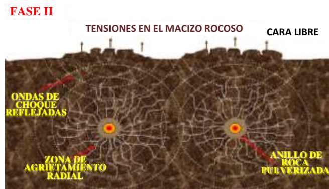
Figura 23 Propagación de las ondas de choque entre los taladros.
