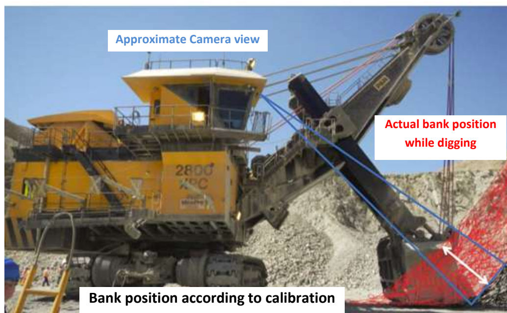
Figura 35 Sistema de toma de fotografías en la pala.
