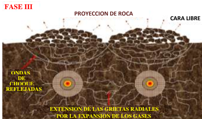
Figura 24 Expansión de los gases.
