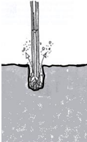
Figura 4,11: Evacuación de detritus Fuente: Elaboración propia
