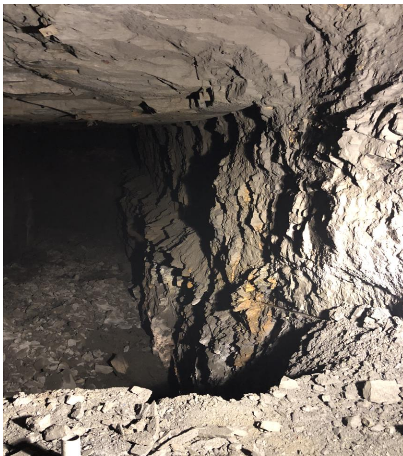
Figura 7,6: Resultado de la voladura de rocas Fuente: Elaboración propia
