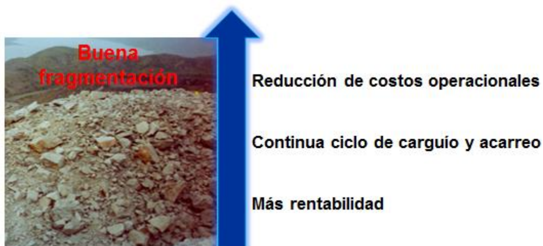
Figura 5,1: Fragmentación adecuada Fuente: Elaboración propia
