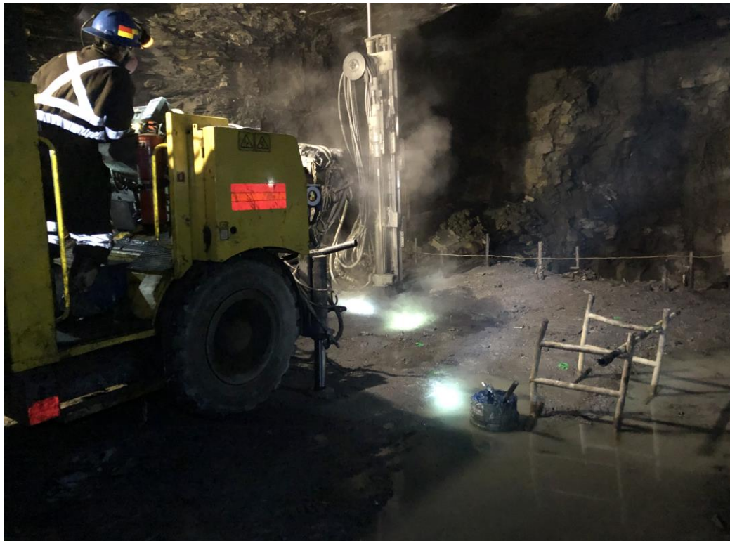
Figura 7,2: Empatando taladro del tajeo 14' - Equipo Simba T1D Epiroc Fuente: Elaboración propia
