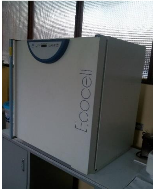
Figura 3.3 Mufla de secado de 25 °C a 250 °C
