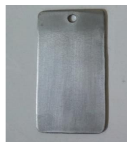
b) Probeta, después de sumergir, no presenta reacción con la solución de Cu-trifosfato
