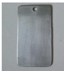
a) Probeta, antes de sumergir en la solución de Cu-trifosfato
