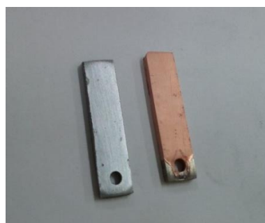
b) Probeta sin y con recubrimiento de cobre
