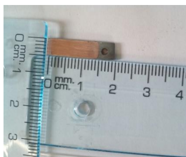
a) Dimensiones de probeta para microscopía electrónica
