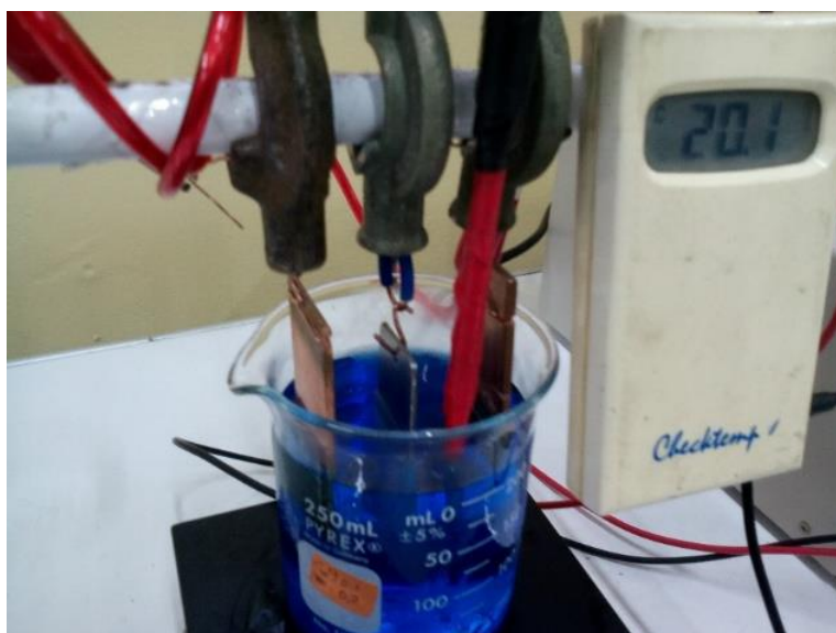
Figura 3.10 Sistema de electrodeposición, nivel laboratorio
