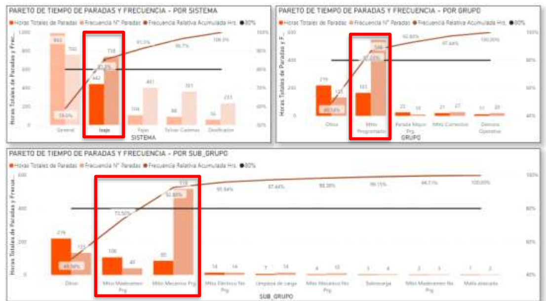
Figura 5.30. Diagramas de Pareto interrelacionados para tiempos de paradas y frecuencias que inciden directamente en el sistema de izaje
