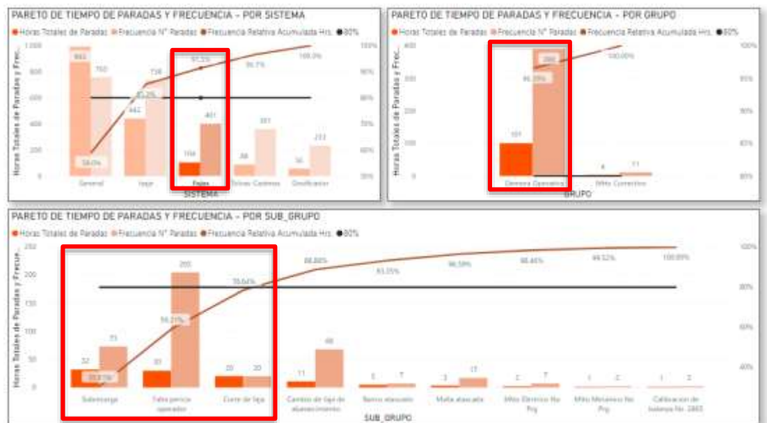
Figura 5.31. Diagramas de Pareto interrelacionados para tiempos de paradas y frecuencias que inciden directamente en el sistema de fajas
