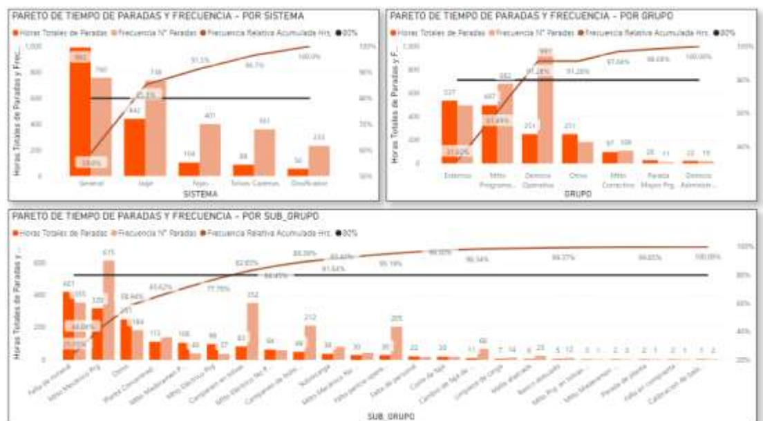
Figura 5.26. Diagramas de Pareto interrelacionados por Sistema-Grupo-Subgrupo para tiempos de paradas y frecuencias en el sistema de transporte vertical
