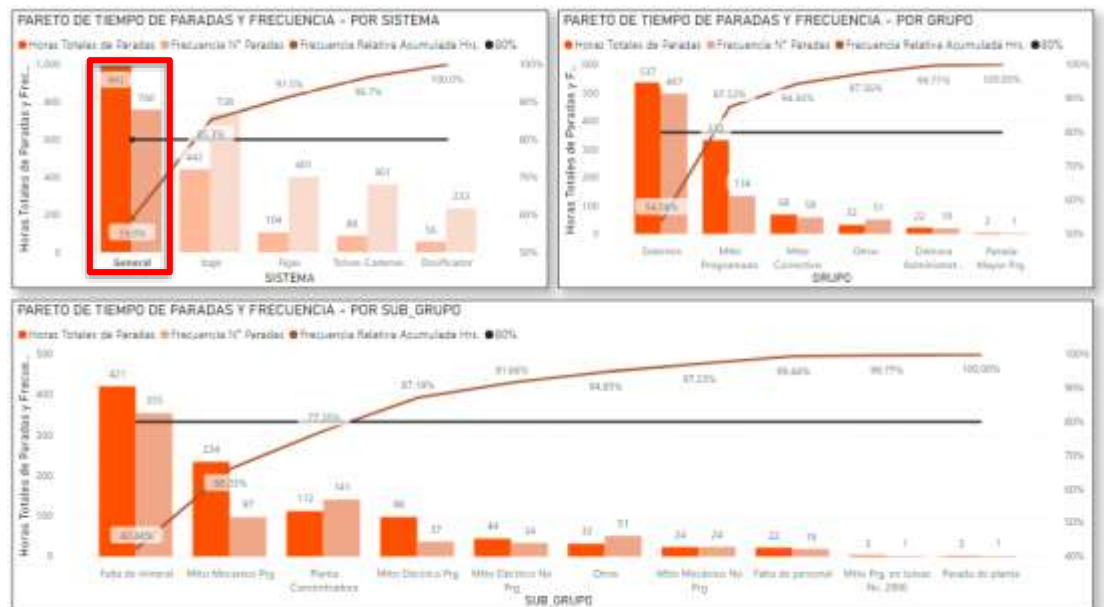
Figura 5.27. Diagramas de Pareto interrelacionados para tiempos de paradas y frecuencias que inciden directamente en el sistema de transporte vertical en general
