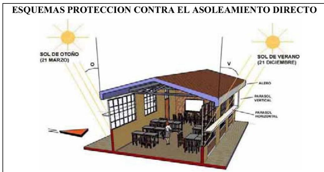
IMAGEN IE8. Esquema de protección contra el asoleamiento directo. Fuente: RNE.
