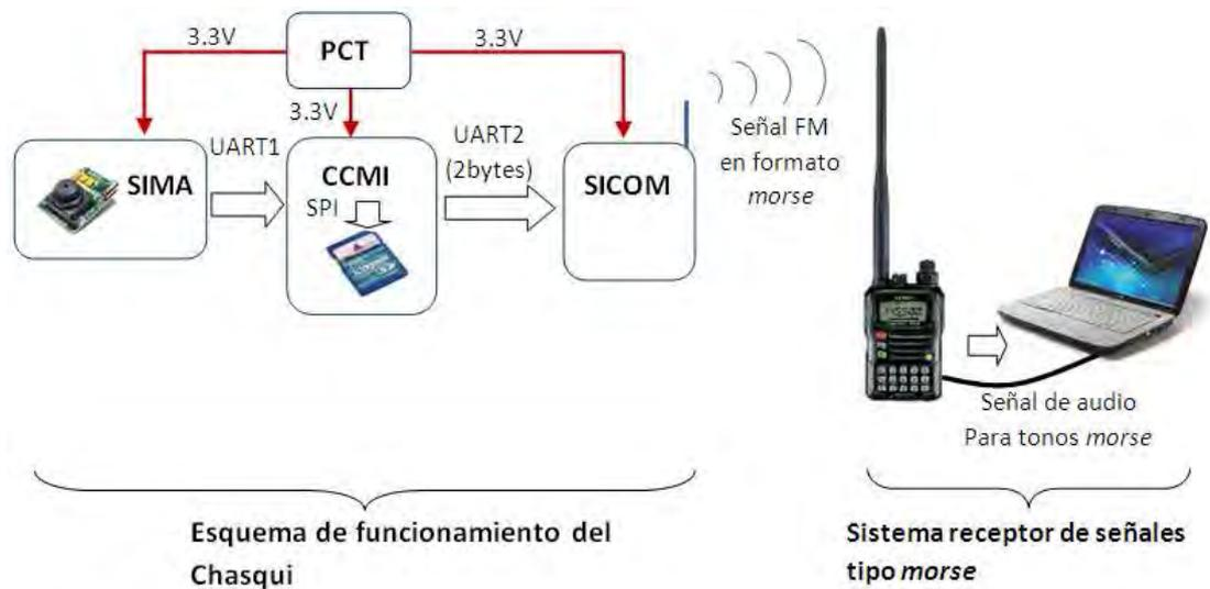
Figura 8-5: Esquema global del sistema en la prueba de Globo cautivo.
