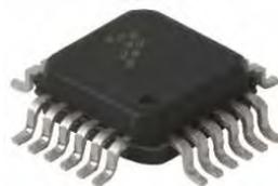
*Figura 5-2: Microcontrolador como parte fundamental en un sistema embebido [4]*
