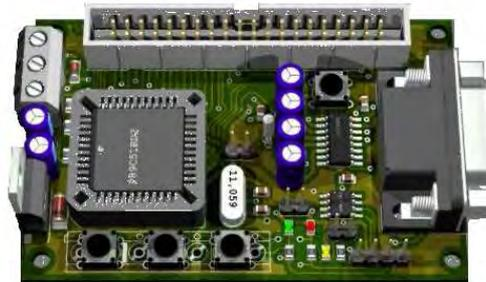
*Figura 5-21: Dibujo 3D del circuito electrónico desarrollado en EAGLE 3D [35].*
