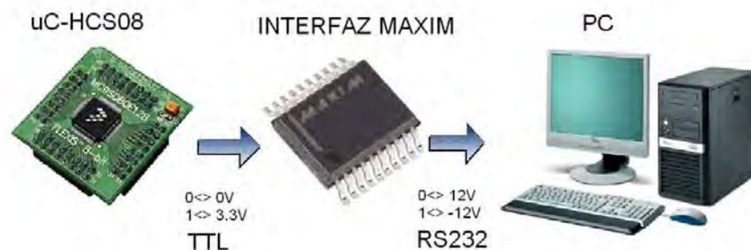
Figura 5-8: Aplicación del circuito integrado MAX3232
