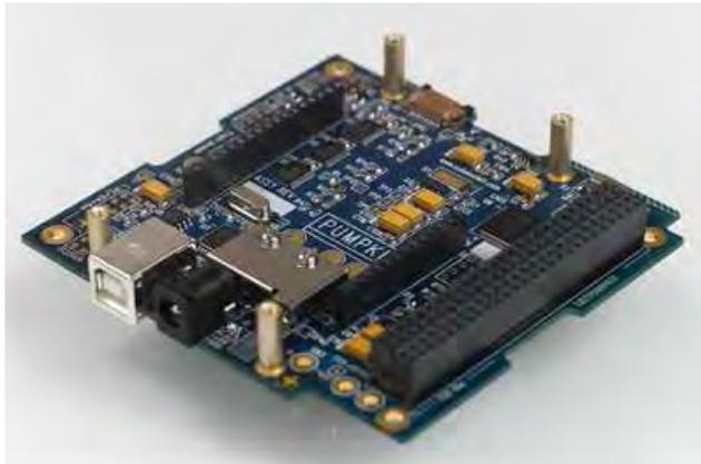
*Figura 3-2: Tarjeta de control central del CubeSat Kit.*
