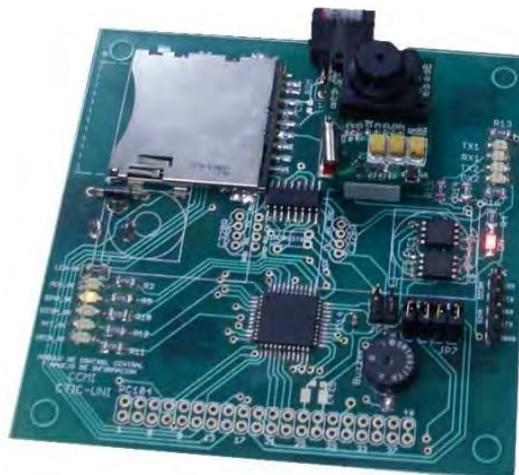
*Figura 4-4: Tarjeta Electrónica del módulo CCMI*
